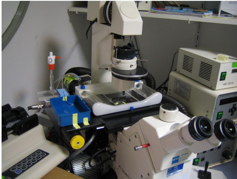
FIG. 2.14: Microscope de fluorescence utilisé à l'Institut Albert Bonniot pour les observations en fluorescence de cellules tumorales adhérentes à la paroi d'un microcanal, et soumises à un flux
