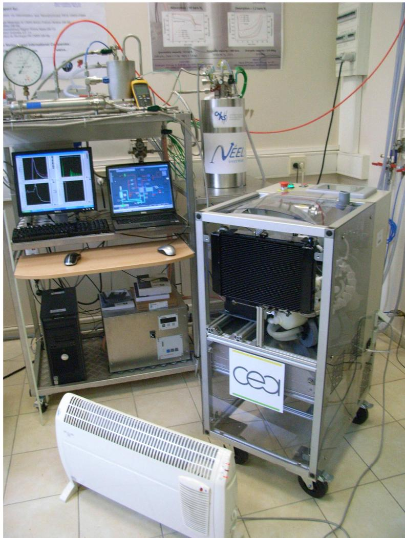
*Très récemment, le réservoir d'hydruure de magnésium NESSH<sub>y</sub> a été utilisé pour alimenter une pile à combustible PEM (démonstrateur EPICEA). Le système a fonctionné durant 44 minutes en alimentant un radiateur consommant 1400 W. Le volume d'hydrogène consommé par la pile étant de 900 NI.*
