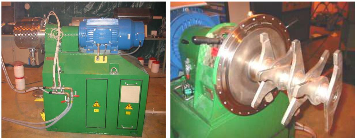
Figure 2.9. Le broyeur ZOZ ; détail des pales à l'intérieur du tambour.
