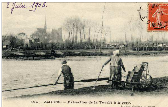
Figure 92 : Carte postale ancienne sur l'extraction de la tourbe dans les hortillonnages. Le personnage de gauche extrait des pains de tourbe d'1 m de long sur 10 cm de large. Cette opération se fait à l'aide d'un « louchet », une bêche très coupante équipée d'un manche de 4 à 6 m de long. Le personnage de droite découpe ces pains en « briques » qui sont stockées sur une brouette pour en faciliter le transport.
