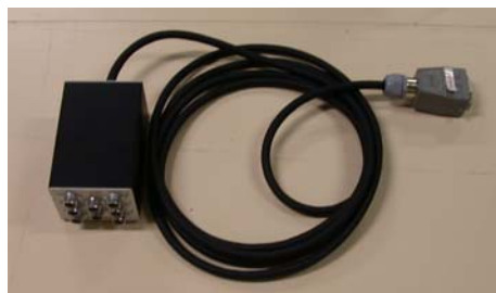
FIGURE C.2 Préamplificateur pour micro à electret conçu au LMA
