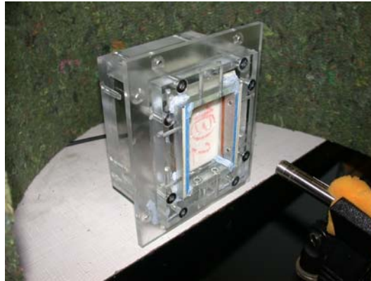
FIGURE 4.10 Photo du montage pour l'évaluation de la linéarité des mousses adaptatives
