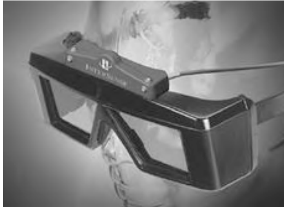
Figure 2 : Une paire de lunettes à obturation munie du capteur de position
