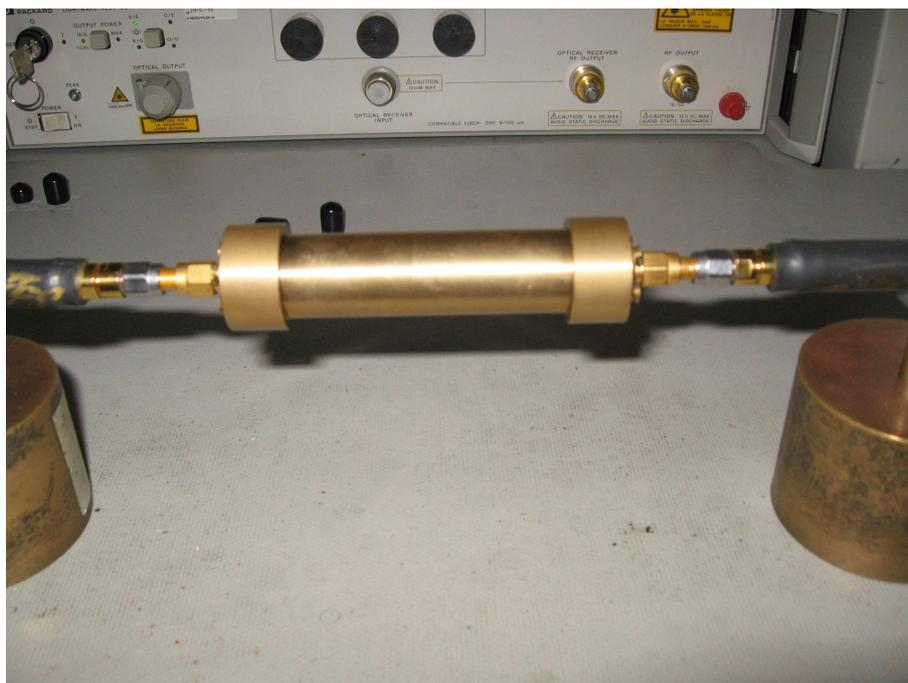
**Figure 11:** Monture coaxiale circulaire en laiton, de longueur  $L=50\text{mm}$ ,  $D = 14,36\text{mm}$  et  $d = 4\text{mm}$  montée sur l'analyseur de mesure (VNA 8510C)
