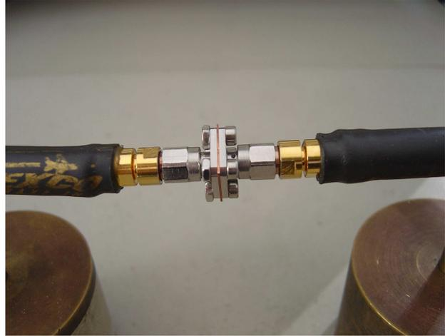
**Figure 6a:** *Eléments de la sonde coaxiale en transmission*
