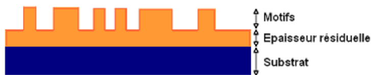
FIG. A.2 – Duo substrat - résine avant la gravure plasma.
