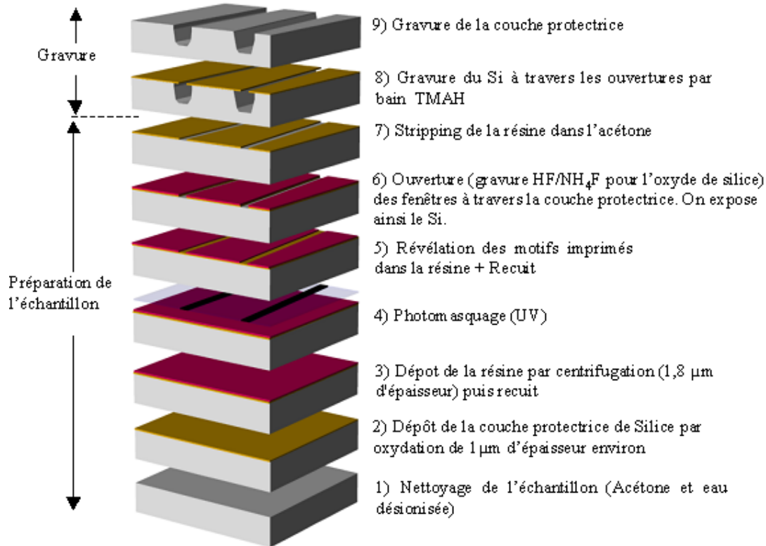
FIG. 3.5 – Vue des différentes phases successives à suivre pour la gravure anisotropique du silicium à travers un masque de silice.
