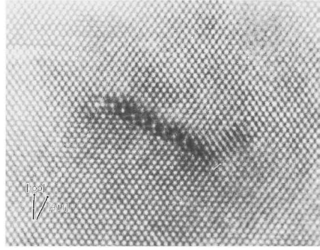
Figure I-12 : Image des défauts {311} par microscopie électronique à transmission en haute résolution [TAK91].
