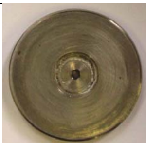
Figure 68 : Dépôt visible de poudre de Y(tmhd)_3 dans la gorge intérieure du couvercle de la cellule d'effusion montrant une mauvaise étanchéité de la cellule.
