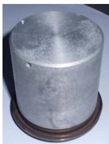
Figure 70 : Gabarit pour la mise en place de l'enroulement du thermocoax entre l'enveloppe thermostatée et la cellule de craquage thermique.
