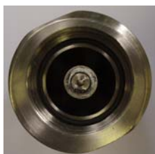
Figure 52 : Dépôt de poudre de Y(\text{tmhd})_3 sur le joint du clapet démontrant la non étanchéité de la cellule d'effusion. Ce joint n'est plus parfaitement dans sa gorge et semble abîmé.
