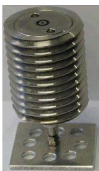
Figure 50 : Photographie de la cellule d'effusion étanche sur sa plaque de support du réacteur organométallique
