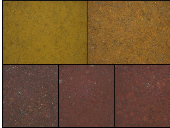
Figure 2 : Photographie des textures et couleurs des poudres. a) Goethite initiale, b) Ech. 1, c) Ech. 2, d) Ech. 3, e) Ech. 4
