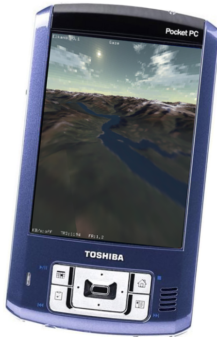
FIG. 6.15: Téléchargement progressif et rendu adaptatif de grands terrains. Modèle du Bugaboos (8 millions de triangles et 208MB of textures) visualisé sur un PocketPC VGA 640x480 avec un taux de rafraîchissement fixé à 2tps et connecté à l'aide d'une connexion WiFi.
