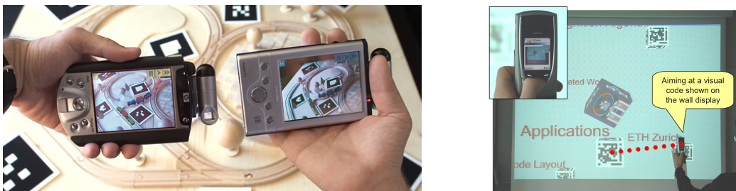
FIG. 8.3: Techniques basées sur la détection de marqueurs : Invisible Train [WS03] et codes visuels de Rohs [Roh04].
