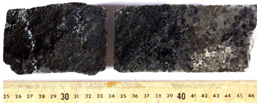
Figure 2.10 : Exemple de contact irrégulier entre une troctolite riche en olivine (à gauche) et un gabbro (à droite). Carotte 243R1_24-48.
