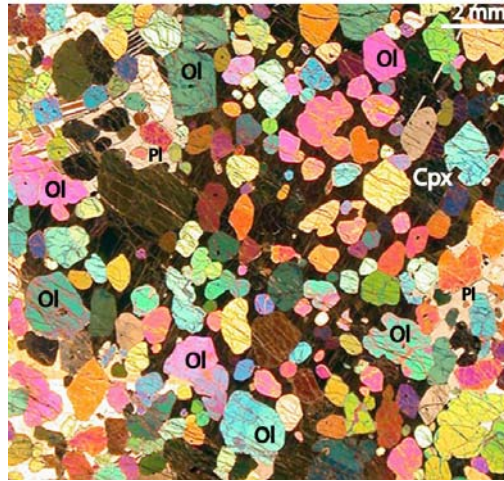
Figure 2.7 : Photo au microscope optique en lumière polarisée d'une troctolite riche en olivine (247R3_16-18). Le clinopyroxène forme une large plage poecilitique englobant des cristaux d'olivines plus ou moins arrondis.
