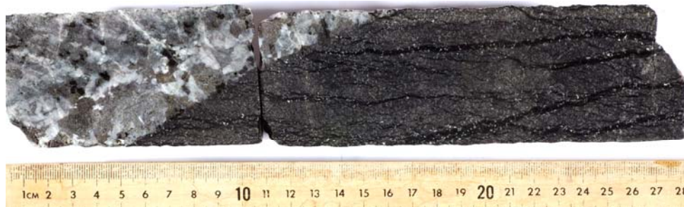
Figure 2.9 : Exemple de contact franc entre un gabbro (à gauche) et une troctolite riche en olivine (à droite). Carotte 235R2_0-28.
