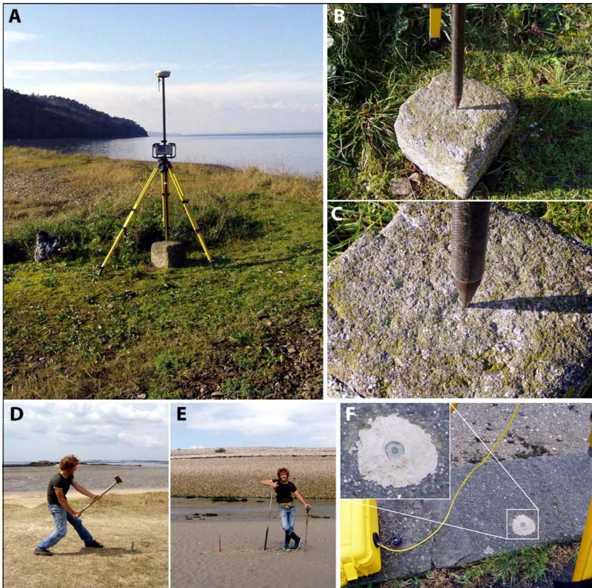
Photographie 30 : A. Station DGPS installée sur une ancienne borne IGN non-géoréférencée à proximité du Sillon des Anglais. B et C. Le centre de la borne est géoréférencé. D et E. Installation de piquets en acier marquant la tête du profil 2, au sommet de la flèche de Bétahon et en arrière du Sillon de Talbert. F. Clou topographique servant de point de mise en station sur le secteur de Troaon.
