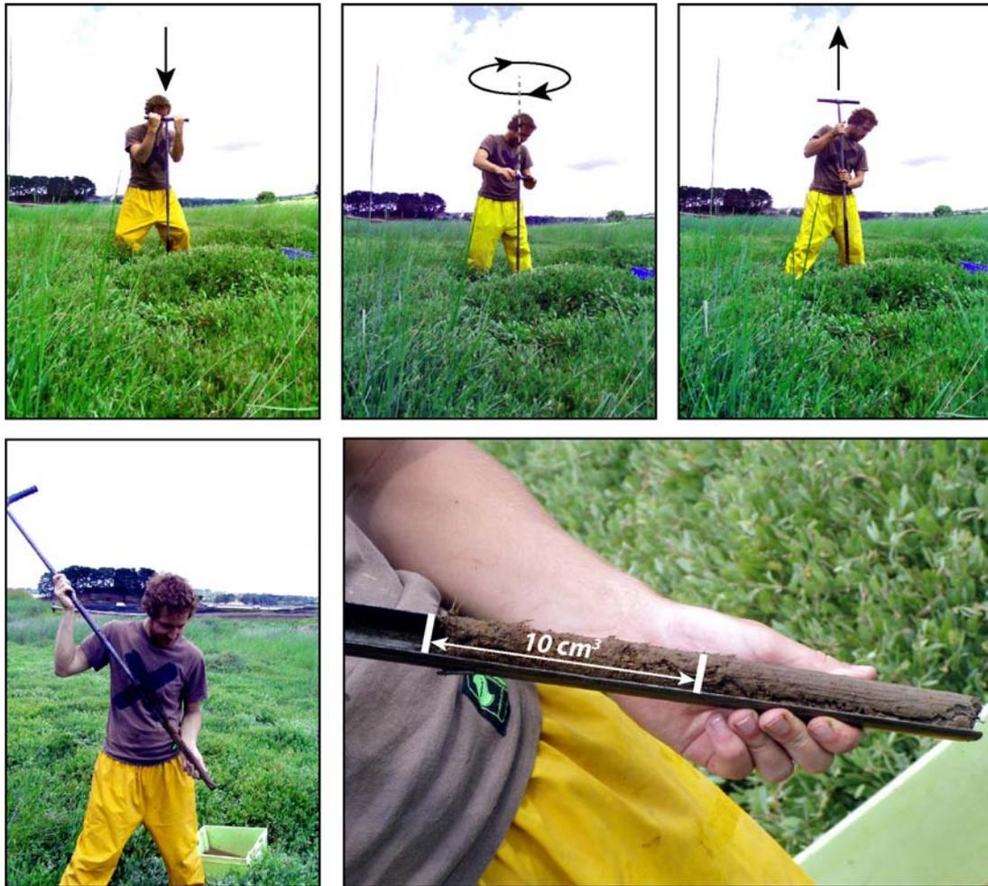
Figure 40 : Techniques de prélèvements sédimentaires et de relevés topographiques le long du transect réalisé dans le marais maritime d'Arun.
