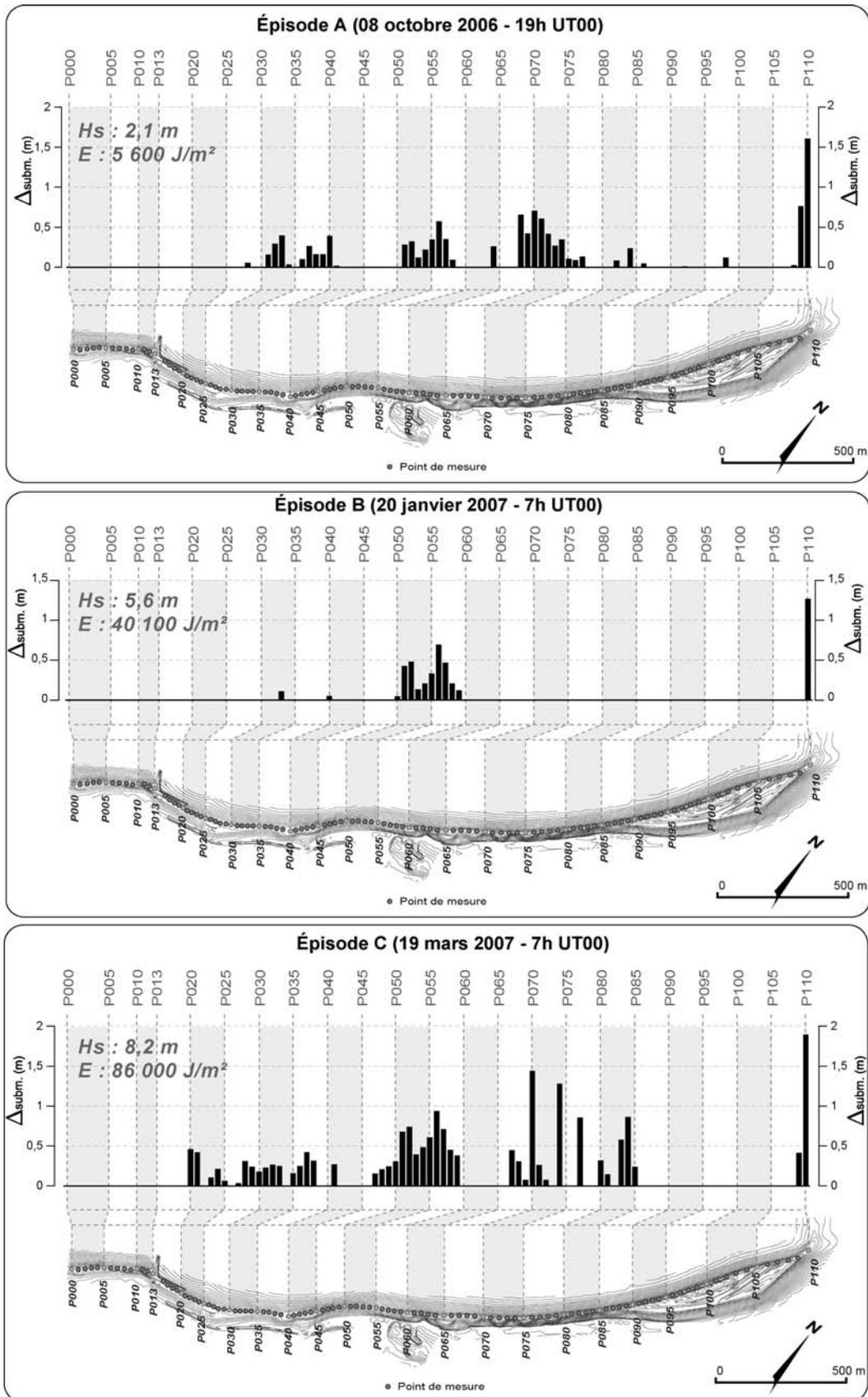
Figure 214 : Epaisseur de la colonne d'eau le long du Sillon de Talbert lors des trois principaux épisodes de submersion marine survenus entre mai 2006 et septembre 2007 ( $H_s$  : hauteur significative des houles au large,  $E$  : énergie des houles).
