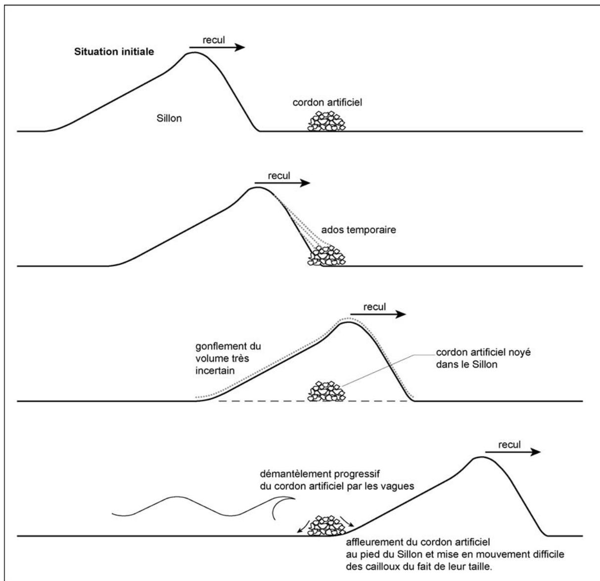
Figure 251 : Impact supposé des cordons artificiels sur le recul du Sillon de Talbert.
