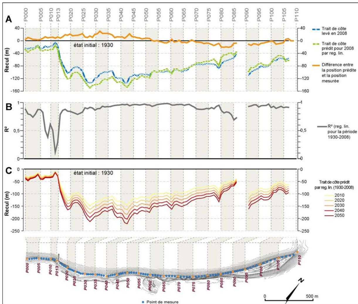
Figure 224 : A. Comparaison entre la position prédite par régression linéaire (période 1930-1998) et la position mesurée du trait de côte en 2008. B. Coefficient de détermination  $R^2$  des régressions linéaires dressées le long des profils de mesure sur la période 1930-2008. C. Position du trait de côte prédite pour 2010, 2020, 2030, 2040 et 2050.
