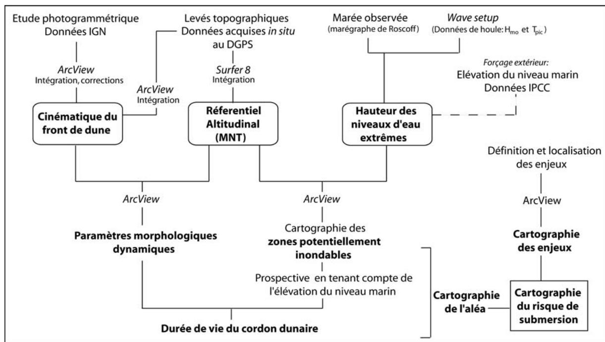
Figure 241 : Organigramme de la méthode préconisée par Cariolet et Suanez (*sous presse*) pour l'estimation du risque de submersion marine. Les phénomènes de *wave setup* sont intégrés à la détermination des niveaux d'eau extrêmes.
