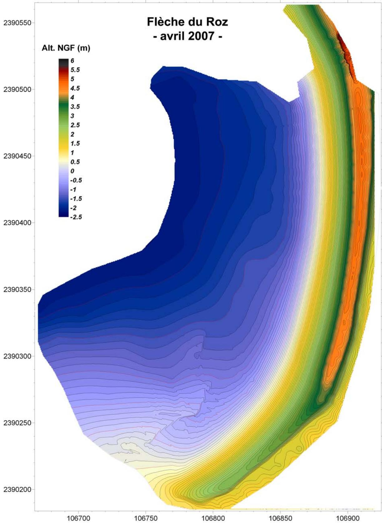
**Annexe 12 – Modèles Numériques de Terrain réalisés sur la flèche de Troaon (résolution : 0,5 m).**
