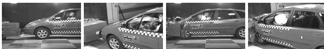
FIG. 3.5 – Analyse spatio-temporelle des mouvements d'un mannequin en crash-test par vision binoculaire.
