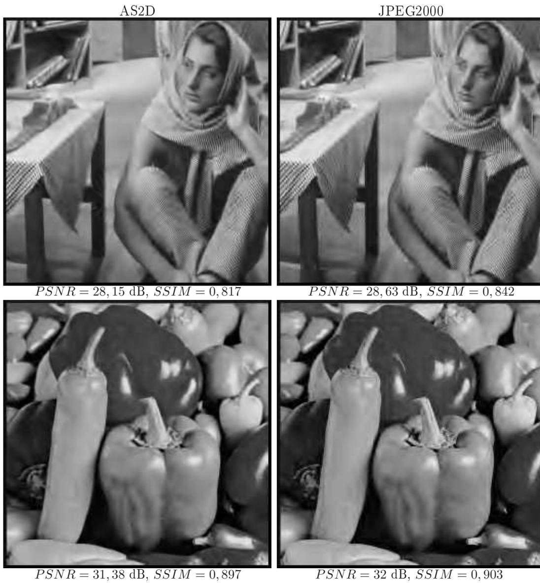
FIG. 4.36 : Résultats de compression visuels à 0,4 bpp.
