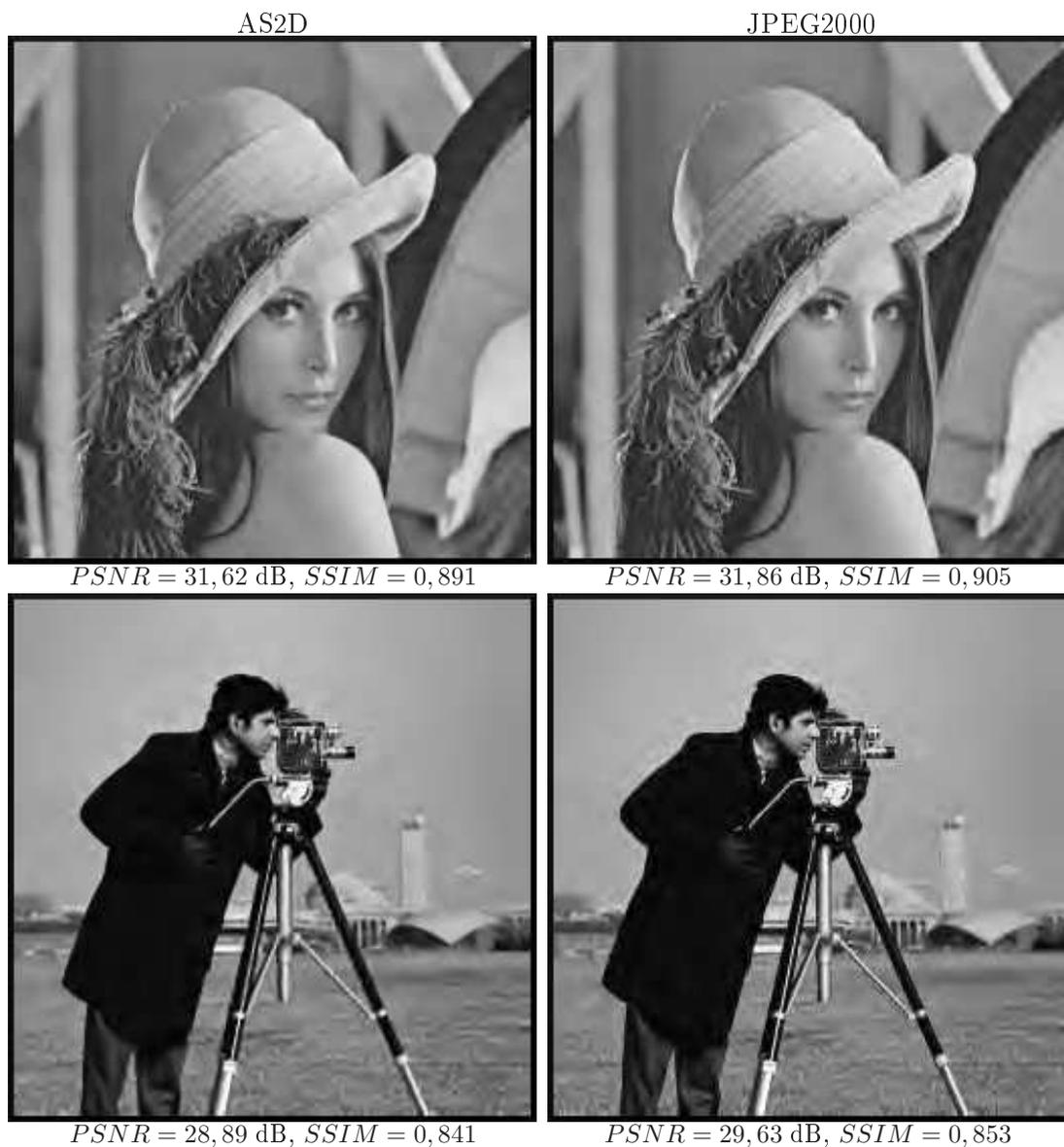
FIG. 4.35 : Résultats de compression visuels à 0,4 bpp.
