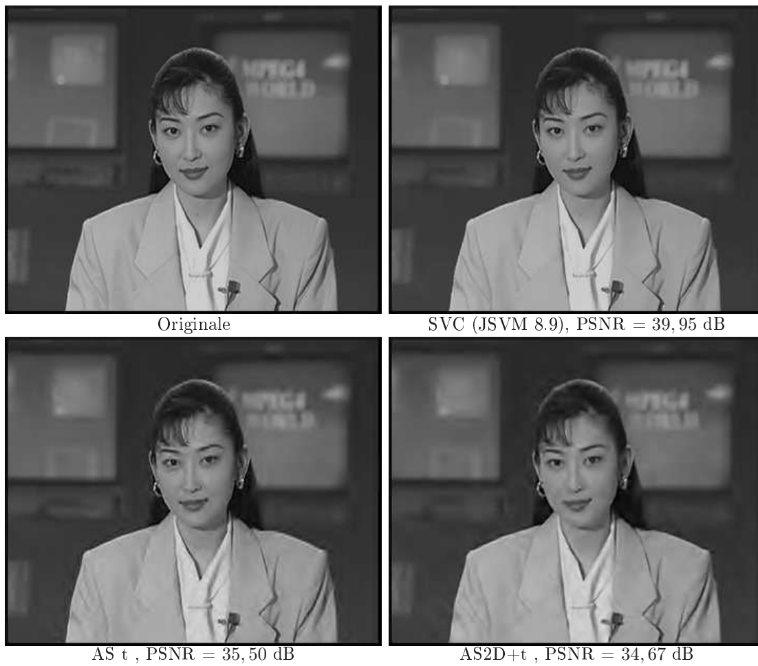
FIG. 5.15 : Image originale au temps t_2 du premier GOF de la séquence Akiyo CIF 30Hz et images reconstruites à 151,5 kb/s par chaque codeur.
