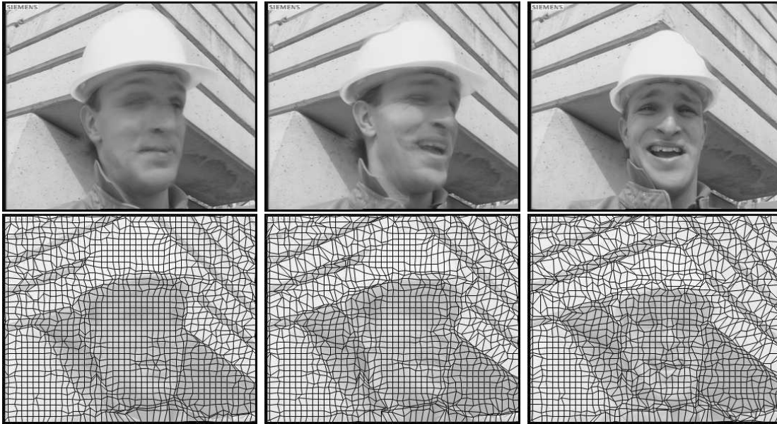
FIG. 5.9 : En haut, images basse fréquence I_{BF} obtenues après alignement temporel pour les trois premiers GOF de la séquence Foreman CIF 30Hz . En bas, modèle de géométrie estimé sur chacune de ces images. Ce modèle est celui utilisé pour toutes les images du GOF compensé en mouvement.
