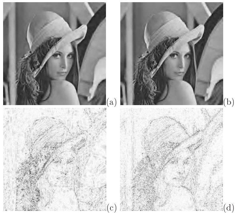
FIG. 4.19 : Influence du pas de quantification. Résultat visuel à 0,4 bpp avec l_a = 8 . (a) Image reconstruite avec Q_g = 0.25 , R_g = 0,150 bpp, PSNR=30,54 dB et (c) Image d'erreur magnifiée par 5. (b) Image reconstruite avec Q_g = 16 , R_g = 0,03 bpp, PSNR=31,39 dB et (d) Image d'erreur magnifiée par 5.
