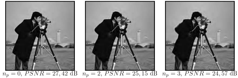
FIG. 4.23 : Image reconstruite à 0,3 bpp en tronquant n_p plans de bits de la géométrie. La part de débit prise par le maillage est 0,04 bpp pour n_p = 0 , 0,022 bpp pour n_p = 2 et 0,017 bpp pour n_p = 3 .
