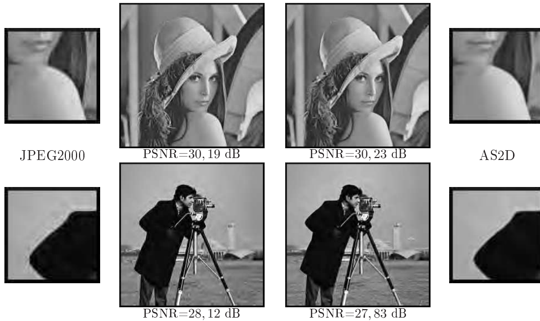
FIG. 4.21 : Comparaisons entre les images reconstruites à 0,3 bpp avec JPEG2000 à gauche et le schéma AS2D proposé à droite.
