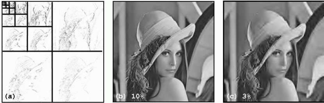
FIG. 1.8 : (a) Décomposition en ondelettes sur 5 niveaux, (b) Reconstruction en gardant 10% des coefficients de plus grande amplitude, (c) Idem en gardant 3% des coefficients de plus grande amplitude. L'ondelette de Daubechies 9/7 [ABMD92] est utilisée ici.
