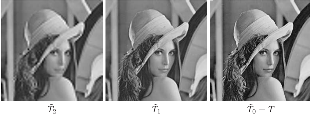
FIG. 4.4 : \tilde{T}_j est l'approximation de T obtenue en mettant à 0 tous les détails d_k[\mathbf{m}] pour k \in \{1..j\} .
