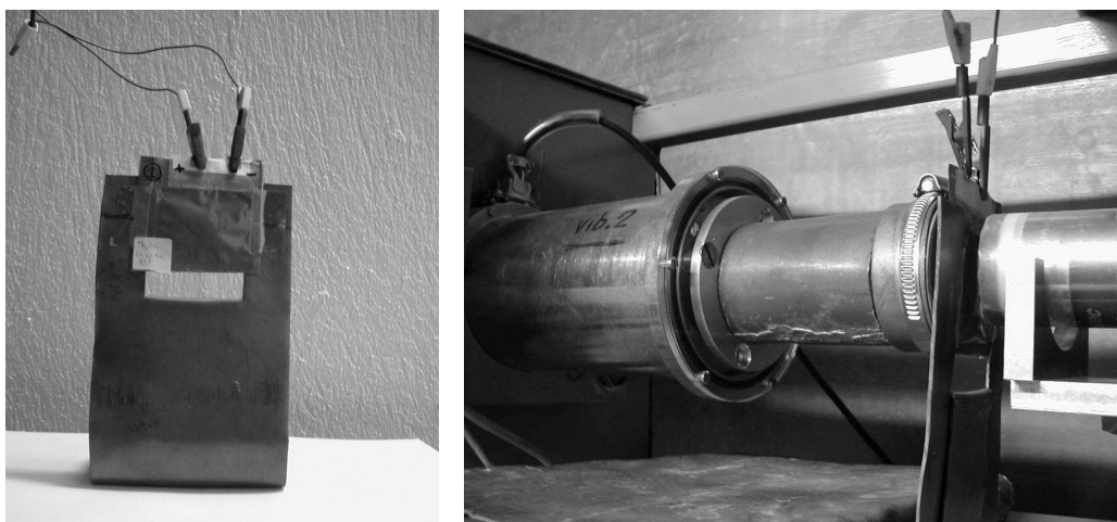
FIGURE 3.20 Montage expérimental pour une étude in situ par la spectroscopie Mössbauer de ^{119}\text{Sn} : Batterie plastique (gauche) et Spectromètre Mössbauer en mode transmission (droite)
