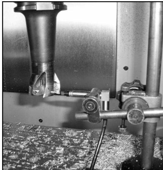
Figure 55. Mesure du battement radial des dents, sur l'outil monté en broche et avec une touche micrométrique.
