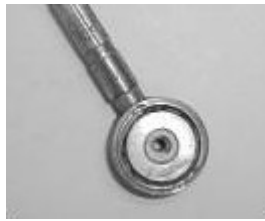
Figure 9. Exemple de jauge industrielle (Jauge de contrainte Brankamp).
