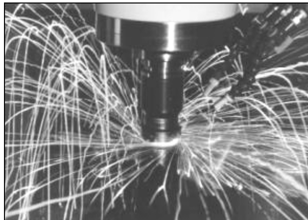
Figure 1. Exemple d'incident de coupe en fraisage [Fur05].
