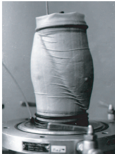
F . 1.2 – Rupture par bande de cisaillement lors d'un triaxial drainé sur sable dense (Desrues et Chambon (2002)) d'après (Colliat-Dangus (1986))
