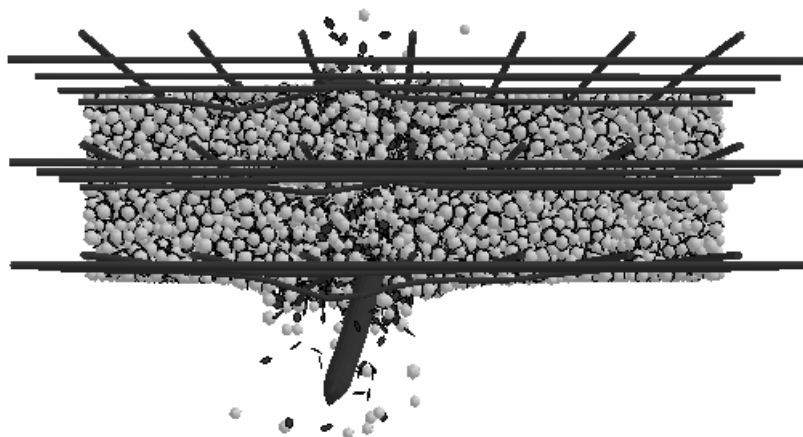
Figure 1-23 : Simulation de l'impact du missile sur une dalle en béton armé (Cusatis et Pelessone, 2006).
