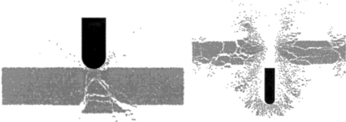
Figure 1-22 : Simulation de l'impact du missile : à gauche, l'écaillage et à droite, la perforation (Magnier et Donzé, 1998).
