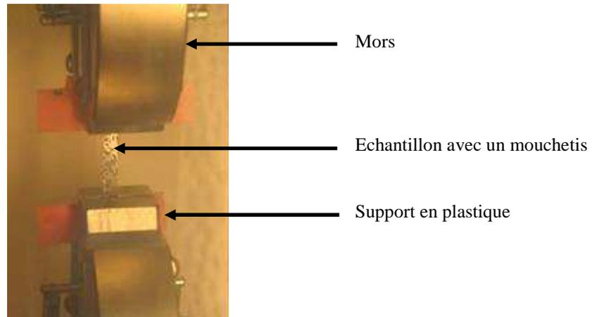
Figure A2.2 : Mouchetis réalisé sur le polymère 3M VHB 4910
