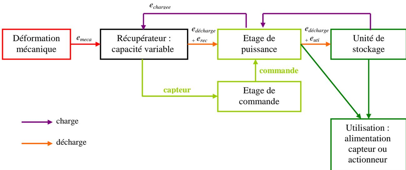
Figure 4.27 : Schéma du système de récupération complet
