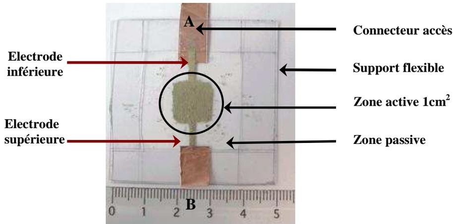
Figure 3.18 : Premier prototype d'un générateur diélectrique
