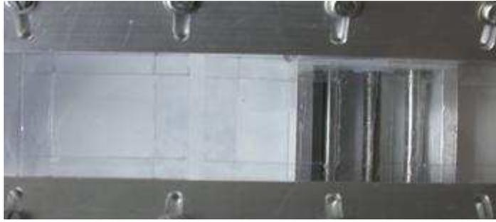
**Étape 5 :** Un cache en plastique est utilisé pour délimiter la zone active. Les électrodes y sont déposées par sérigraphie manuelle.
