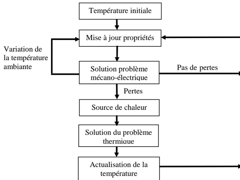
Figure 3.1 : Couplage au sein d'un polymère diélectrique
