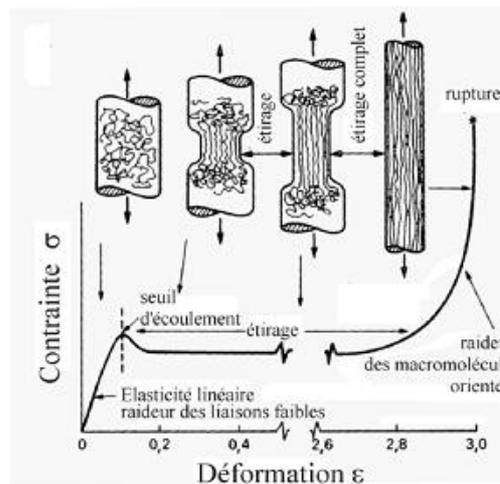
Figure 2.28 : Cristallisation du caoutchouc naturel avec l'étirage [ASH]
