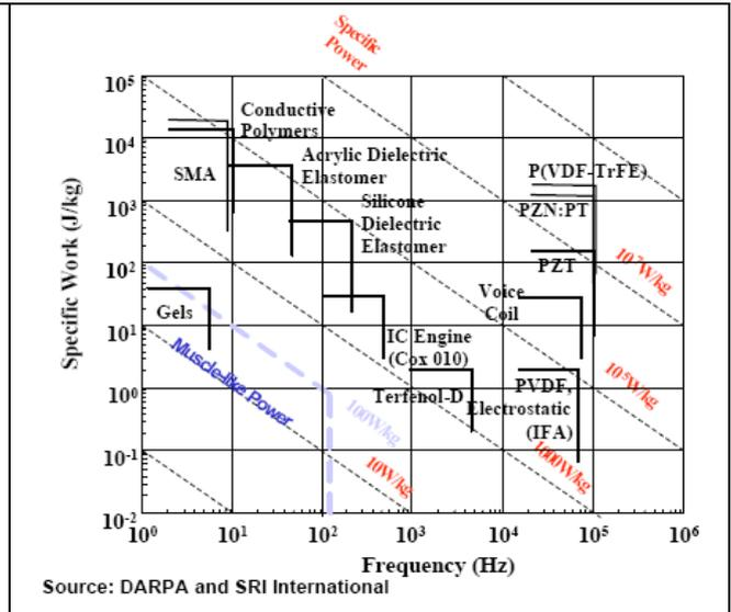
Figure 1.2 : Travail spécifique-fréquence pour différents matériaux électroactifs
