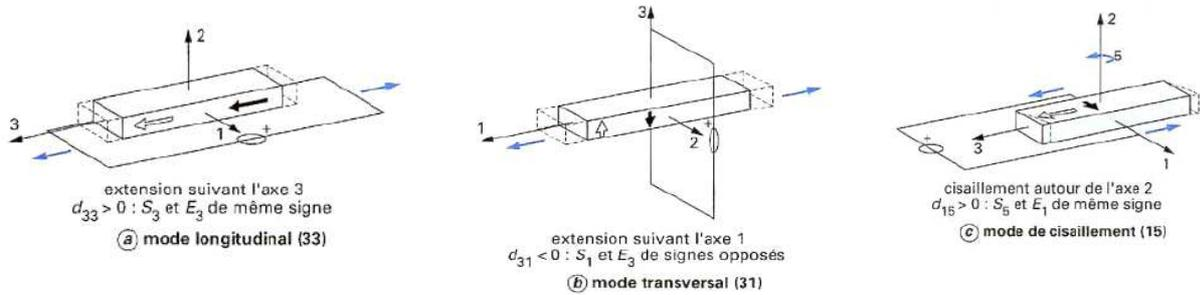
Figure 1.5 : Couplages élémentaires piézoélectriques [NOG 1996]
