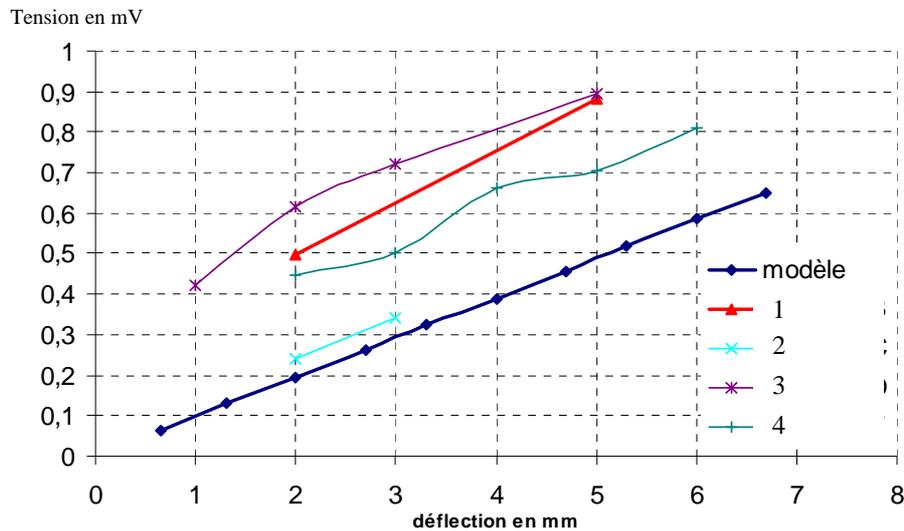
Figure A1.2 : Tensions de sortie en fonction de la déflexion en entrée pour une fréquence de 10Hz
