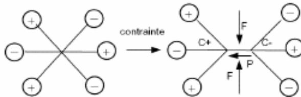
Figure 1.4 : Déplacement du barycentre des charges au niveau de la maille cristalline [GUI 2006]
