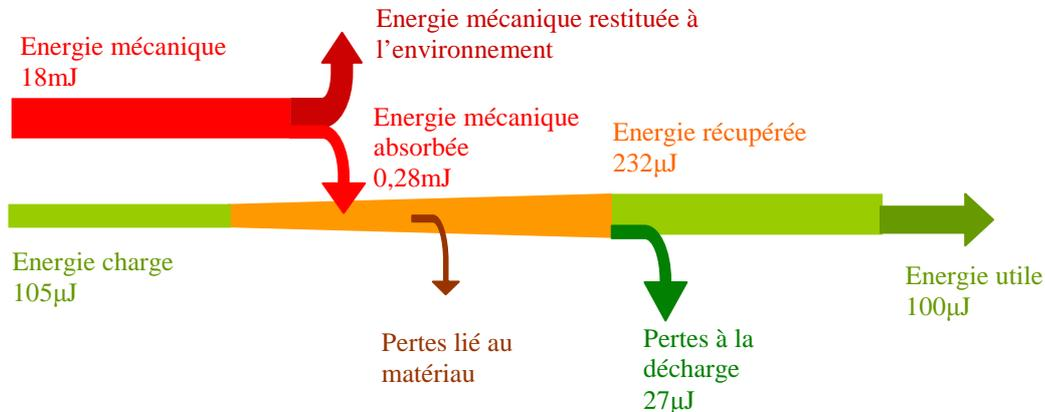
Figure 4.23 : Energie réellement mises en jeu
