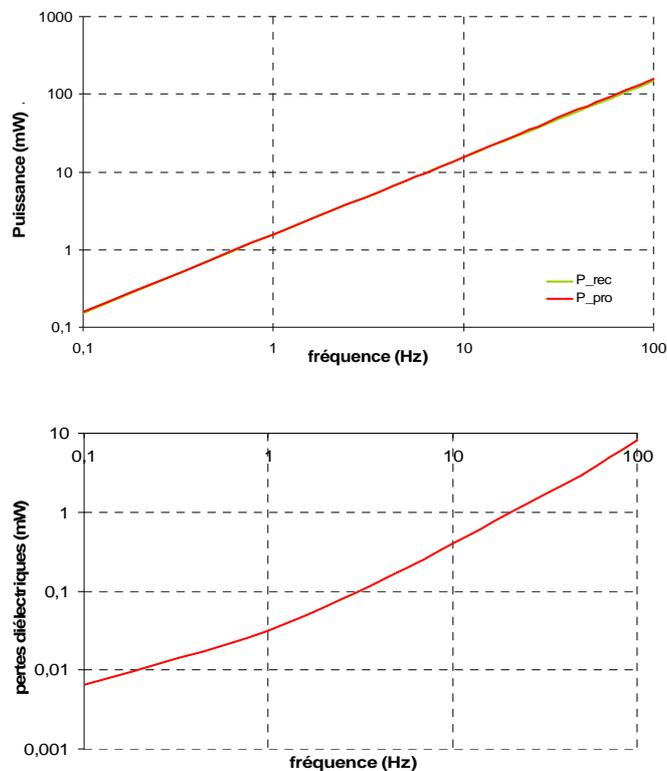
Figure 3.12 : Puissance récupérée en fonction de la fréquence
