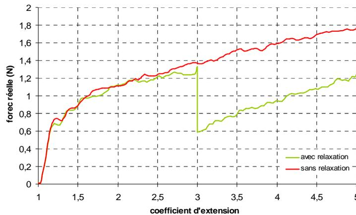
Figure 2.11 : Traction uniaxiale polymère précontraint et non précontraint
