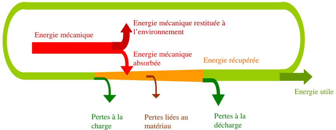
Figure 3.6 : Bilan énergétique global de la structure
