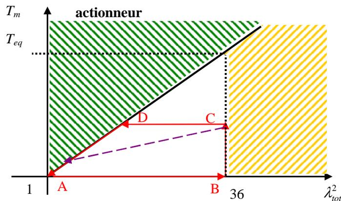
Figure 3.9 : Cycle générateur avec visualisation des zones interdites
