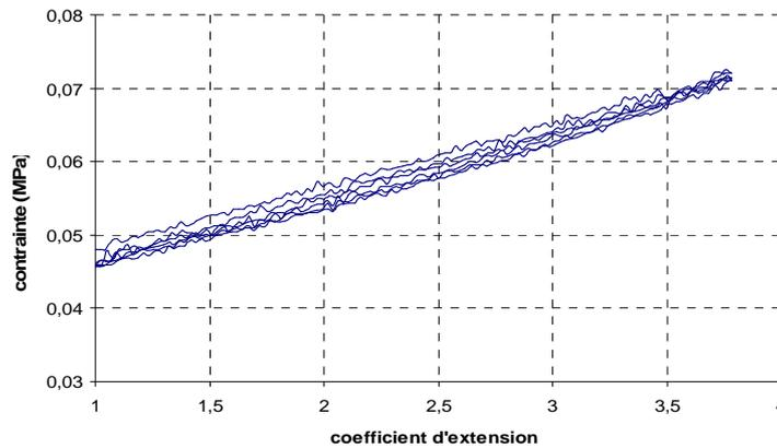
Figure 2.11 : Cycle d'hystérésis pour le polymère 3M VHB 4910
