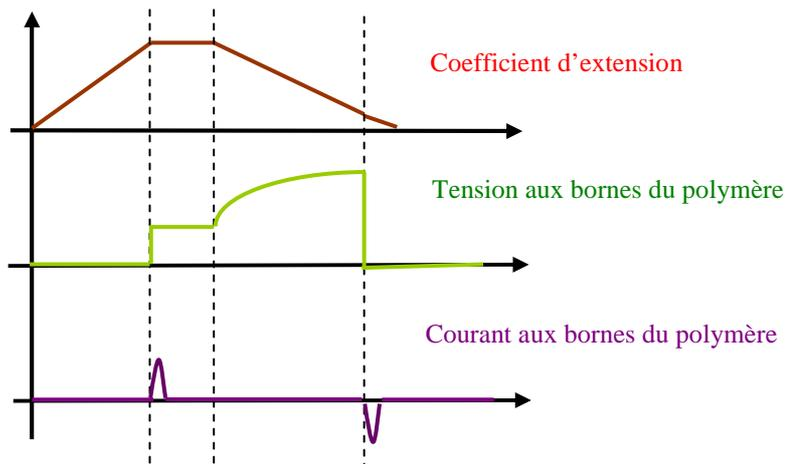
Figure 4.14 : Signaux électriques théoriques pour un cycle à charge constante
