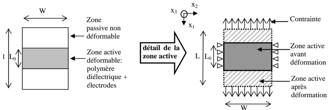
Figure 4.8 : Forme du patch et déformation active
