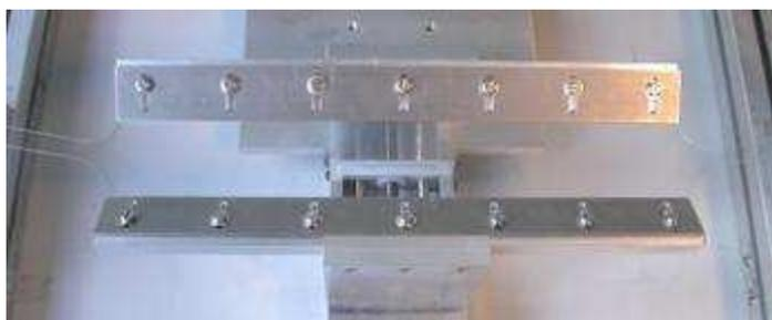
**Étape 4 :** Après relaxation du matériau, le polymère est pris en sandwich entre deux supports flexibles, pour pouvoir maintenir la pré-déformation et sortir la membrane de ce support rigide.
