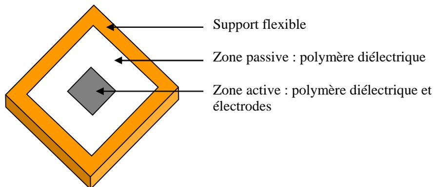
Figure 3.3 : Forme type d'un générateur en déformations biaxiales
