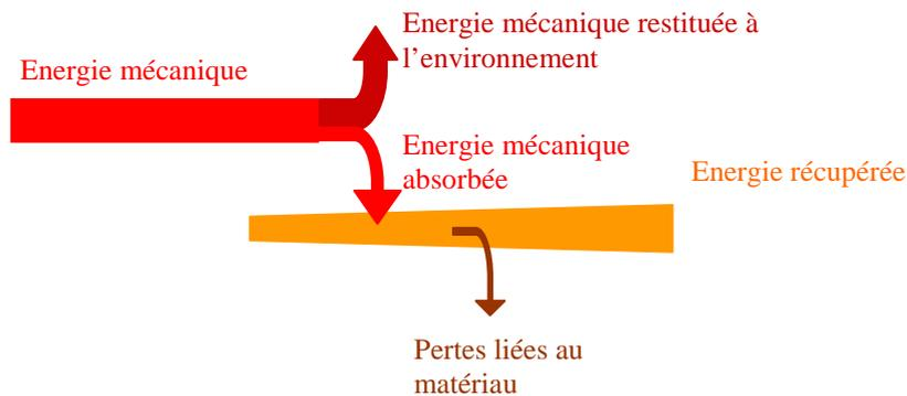
Figure 3.5 : Schéma de l'étage de conversion
