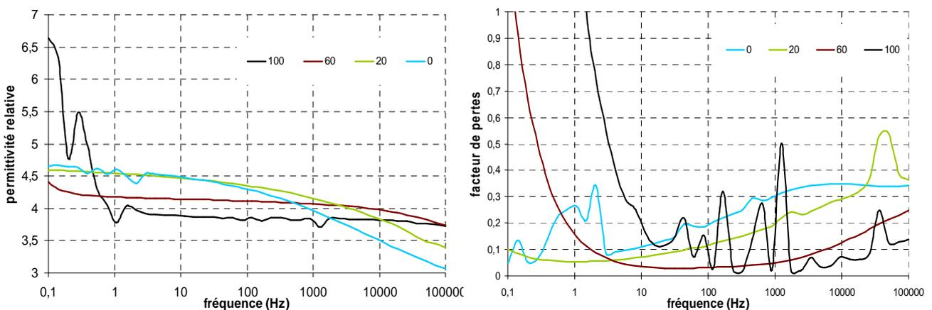
Figure 2.31: Permittivité de l'échantillon précontraint en surface de 16 en fonction de la fréquence
