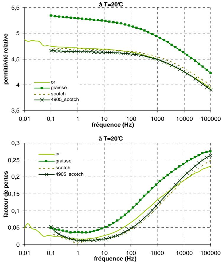
Figure 2.21: Effet du type d'électrode sur la permittivité du polymère
