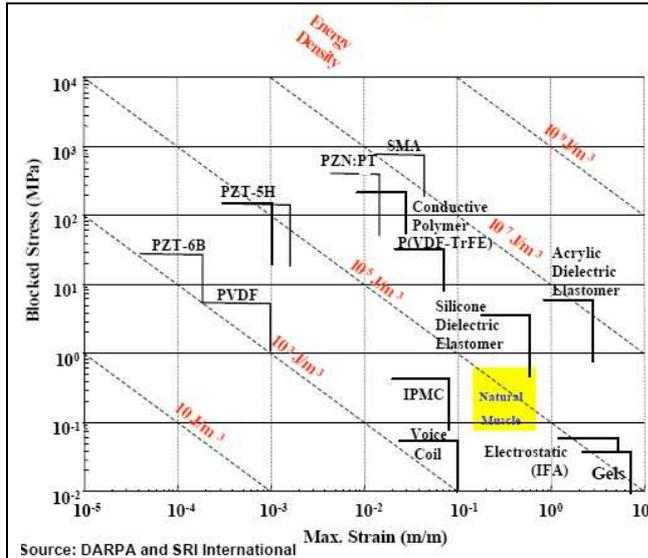
Figure 1.1 : Contrainte-déformation pour différents matériaux électroactifs
