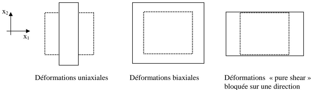
Figure 3.2 : Trois déformations de base dans le plan
