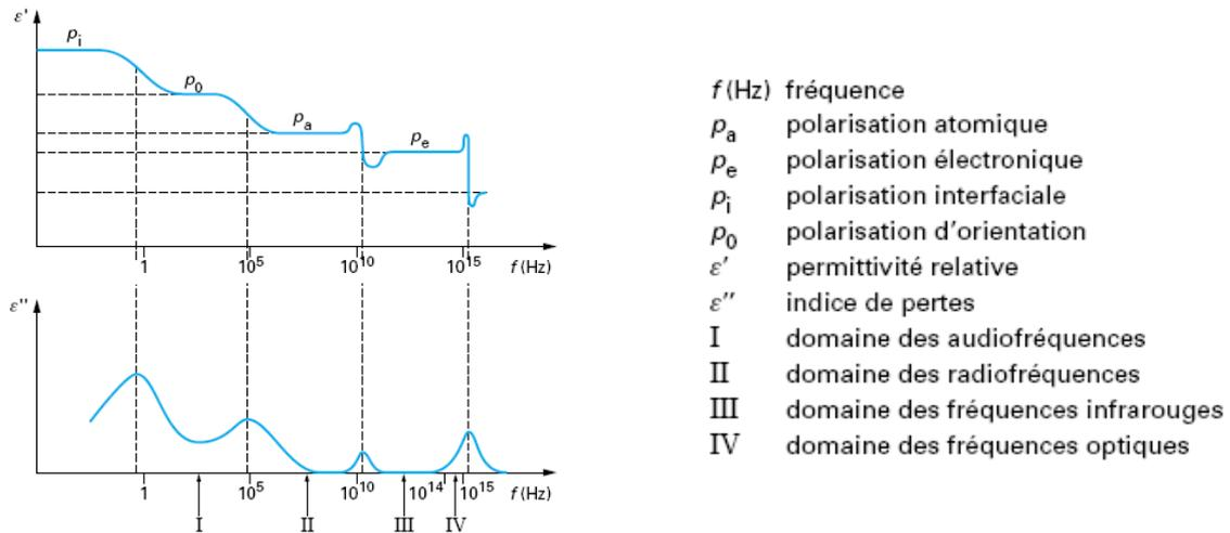
Figure 2.15 : Polarisation au sein d'un matériau diélectrique [DUB]
