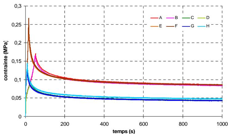
Figure 2.8 : Courbes en relaxation pour les 8 essais réalisés
