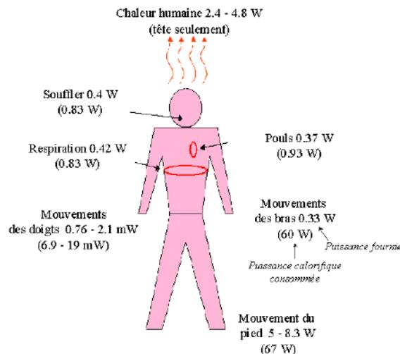
Figure 4.2 : Energie dissipée par le corps humain [POU 2004]
