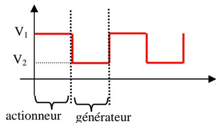
Figure 3.16 : Tension de commande pour les cycles générateur
