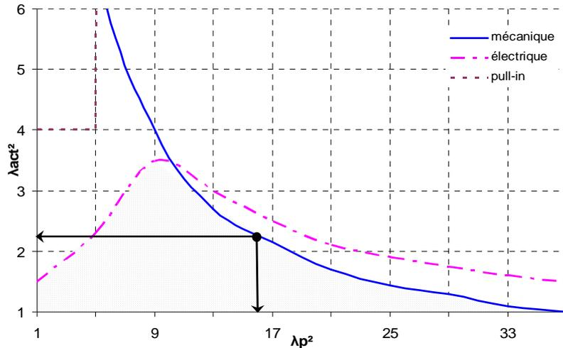
Figure 3.8 : Zone de fonctionnement du polymère diélectrique 3M VBH 4910 en déformation biaxiale
