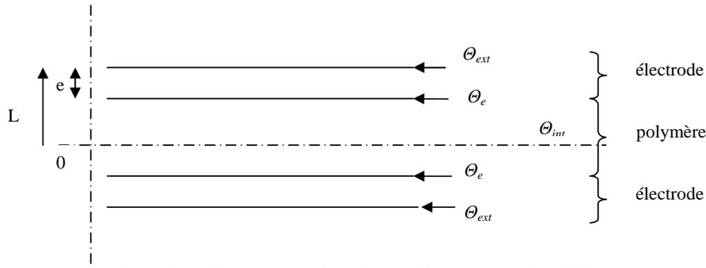
Sur la figure 3.7,  $\Theta_{ext}$  est la température extérieure,  $\Theta_e$  celle de l'électrode et  $\Theta_{int}$  celle du polymère.
