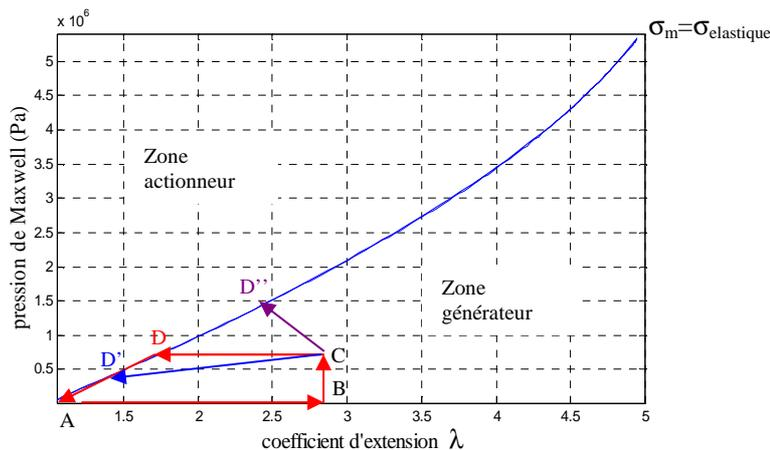
Figure 2.4 : Zones actionneur-générateur d'un polymère diélectrique
