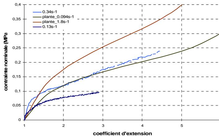
Figure 2.5 : Loi de comportement du matériau 3M VHB 4910 pour différentes vitesses de sollicitation
