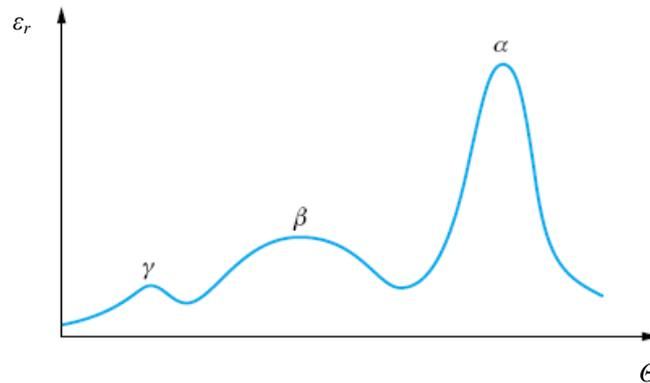
Figure 2.17 : Trois types de polarisation d'orientation [DUB]
