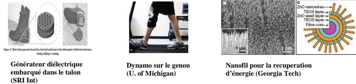
Figure 4.3 : Dispositifs de récupération d'énergie mécanique d'origine humaine
