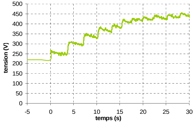
Figure 4.25 : Evolution de la tension aux bornes de la capacité de stockage
