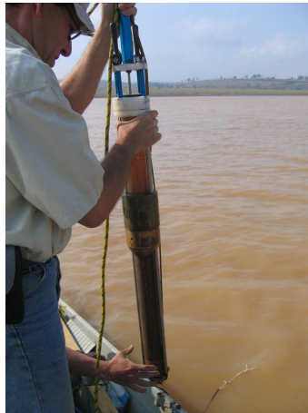
Figure I-17 : Carottage dans le réservoir de Cointzio (mai 2006) à l'aide du carottier UWITEC.
