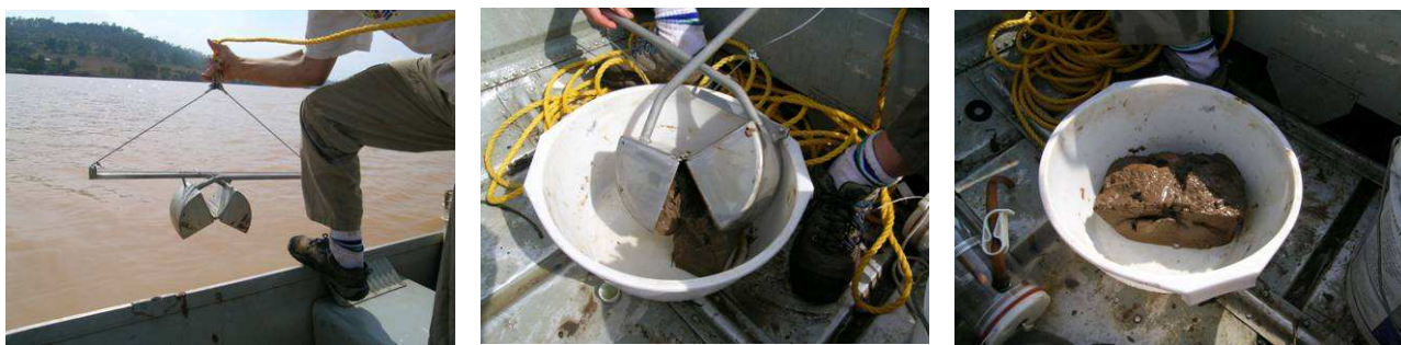
Figure 4 : Prélèvement de sédiments de surface à l'aide de la benne (Photos par M. Esteves)
