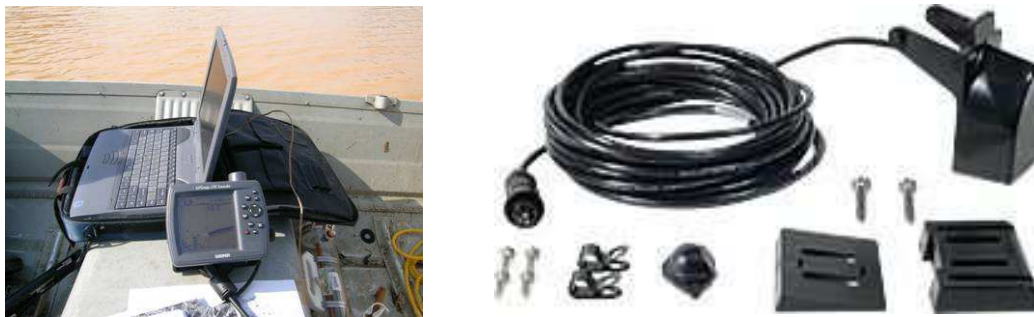
Figure 1 : a) Echosondeur GPSMAP 178 (photo M. Esteves) ; b) Transducteur (200 KHz)
