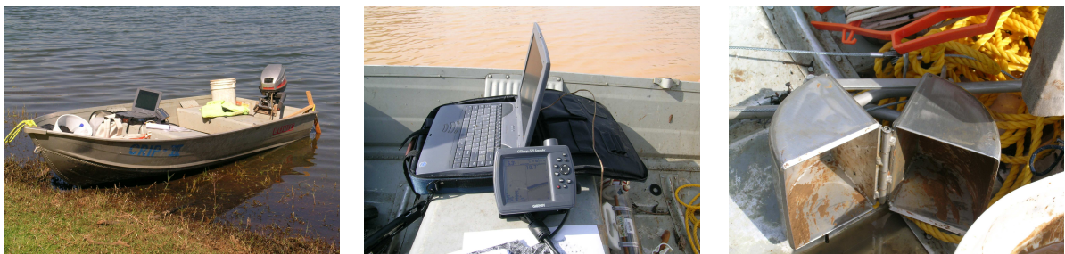
Figure I-14 : Illustrations du protocole expérimental développé pour les missions courtes durées : bateau, échosondeur, benne à sédiment...
