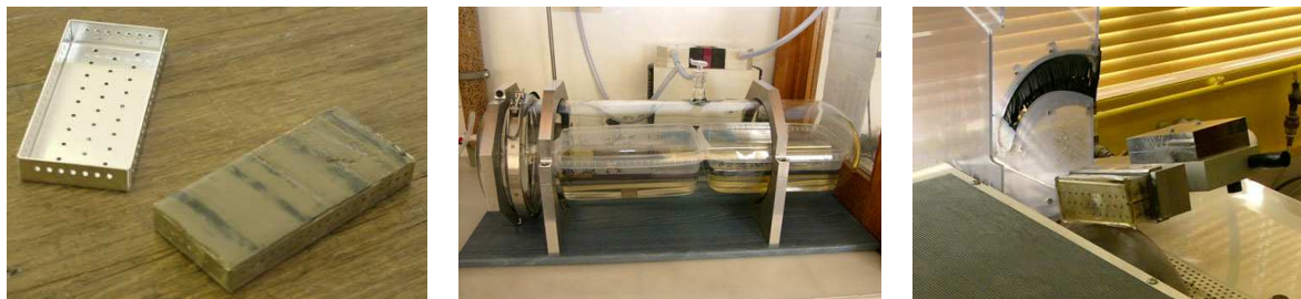
Figure I-23 : Etapes de fabrication d'une lame mince imprégnée, du prélèvement de sédiment à la découpe de la lame indurée (crédit photos S. Zaragosi, http://www.epoc.u-bordeaux.fr ).
