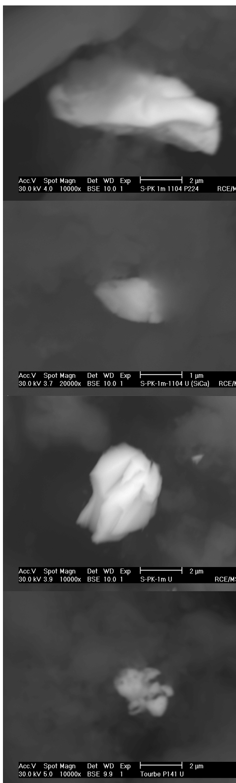
Photographie 2 : Photographies de particules d'U et mixtes d'U-Th, par MEB avec une tension de 30 kV réalisées en mode « électrons rétrodiffusés » (CEA DIF/DASE/SRCE/LMSG).
