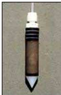
Photographie 6 : Lysimètre PRENART© en PTFE/quartz (diamètre 21 mm ; longueur 95 mm ; taille de pore 2 \mu\text{m} ).
