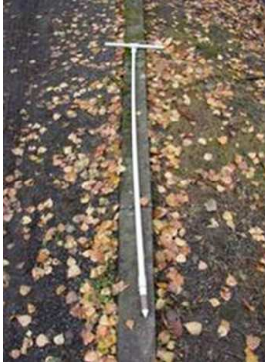
Photographie 5 : Canules en polypropylène permettant la mise en place des cellules poreuses en PTFE/Quartz à 5 m du piézomètre PZPK.
