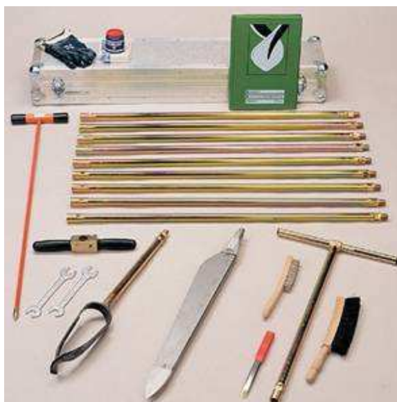
Photographie 9 : Set de tarières en acier traité (tarière Edelman à gauche et tarière « russe » en forme de cylindre à droite), utilisé lors des prélèvements de sol manuels (SEDEC France-Eijkelpamp). La tarière « russe » fait 0,5 m de longueur, 60/52 mm de diamètre extérieur/intérieur et 0,5 L de volume.
