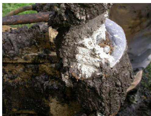
Photographie 11 : Photographie de tourbe noire humide prélevée entre 0,5 et 1 m de profondeur (A), d'argile grise prélevée entre 3,1 et 3,6 m de profondeur (B), des alluvions calcaires dans lesquelles se trouve la nappe alluviale (C) et du substratum marno-calcaire (partie blanche). Ces deux derniers ont partiellement prélevés lors de la pose du nouveau forage PZVP en septembre 2006.
