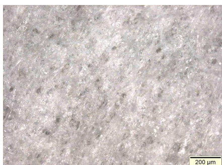
Figure 44 - Vue au microscope optique du filtre Millipore® - La taille des pores donnée par le fabricant est 10 µm.
