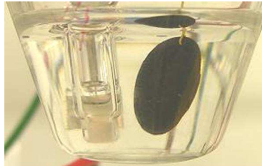
Figure 105 - Voltampérogrammes de consommation du gaz typique d'un échantillon NP Pt-2 / NT 1/1, 10 mL filtrés et photographie de l'électrode après cette étape : feutre et couche active apparaissent sombres.
