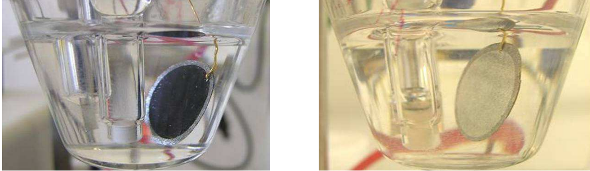
Figure 104 - Photographies d'électrodes NP/NT 1/1, 10 mL filtrés, juste après leur immersion dans l'électrolyte - à gauche : Pt-1, la couche active est sombre (imprégnée d'électrolyte) et le feutre est brillant (plein de gaz) ; à droite : Pt-2 : la couche active et le feutre sont brillants.
