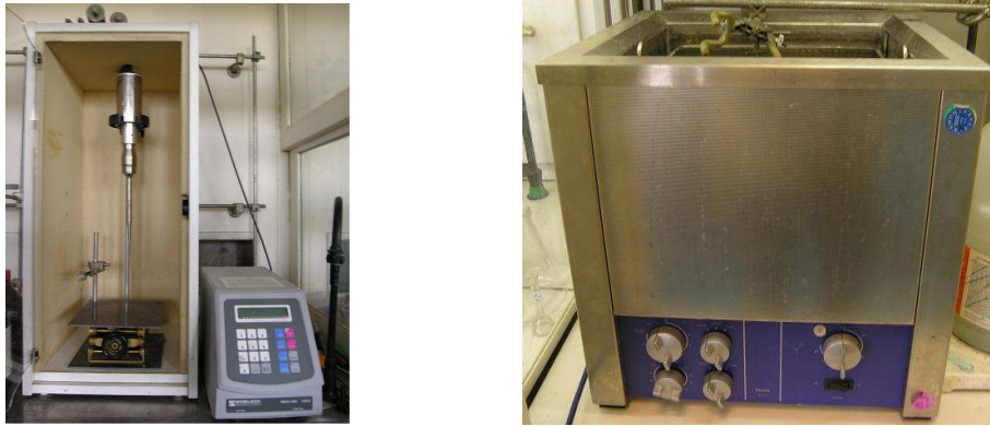
Figure 30 - Appareillage pour traitements ultrasonores du laboratoire : sonde (à gauche), bac (à droite).
