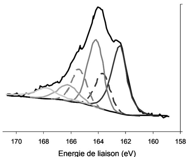
Figure 150 - Spectre XPS du signal du soufre S 2*p* sur un film de Langmuir-Blodgett mixte de nanoparticules Pt-1 et sa déconvolution<sup>25</sup>.
