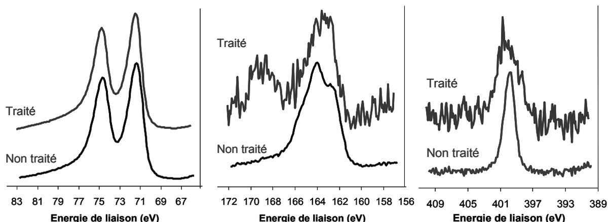
Figure 124 - Signaux XPS normalisés du platine Pt 4*f* (à gauche), du soufre S 2*p* (milieu) et de l'azote N 1*s* (droite) pour une électrode Pt-1/NT 1/1 / feutre traitée électrochimiquement (borne d'oxydation à 1,25 V) comparés aux signaux d'une électrode non traitée.
