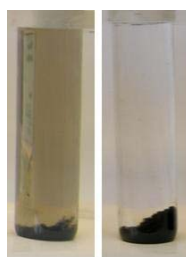
Figure 34 - Coloration résiduelle du surnageant d'une association NP Pt-1/NT réalisée avec le DMSO comme unique solvant (à gauche) - comparaison avec une association réalisée dans des conditions identiques avec une dispersion de nanotubes dans l'isopropanol (à droite).
