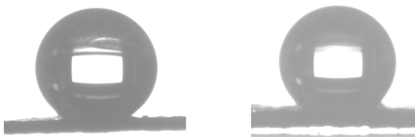
Figure 71 - Clichés de mesures d'angle de contact d'une goutte d'eau avec des dépôts de nanotubes seuls - à gauche 10 mL filtrés, angle 145^\circ ; à droite 40 mL filtrés, angle 130^\circ .
