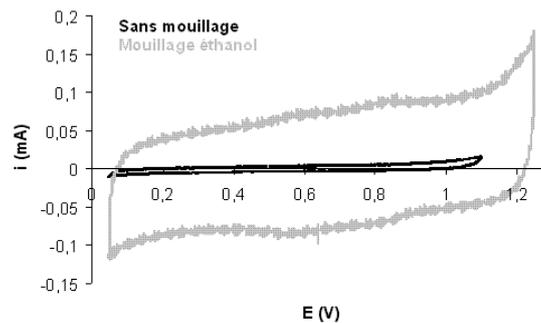
Figure 88 - Voltampérogrammes d'une électrode en feutre de carbone non mouillé et après imprégnation par mouillage à l'éthanol - solution HClO<sub>4</sub> 1 mol/L, désoxygénée par bullage Ar, 100 mV/s.
