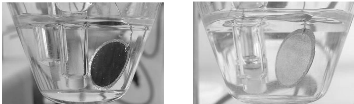
Figure 104 - Photographies d'électrodes NP/NT 1/1, 10 mL filtrés, juste après leur immersion dans l'électrolyte - à gauche : Pt-1, la couche active est sombre (imprégnée d'électrolyte) et le feutre est brillant (plein de gaz) ; à droite : Pt-2 : la couche active et le feutre sont brillants.
