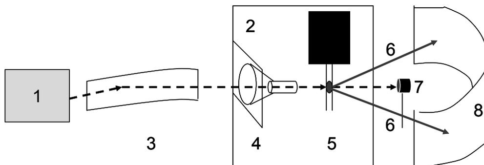
Figure 151 - Montage utilisé pour la diffraction des Rayons X aux grands angles ; 1) anode tournante en cuivre, 2) chambre à vide en béryllium, 3) monochromateur, 4) collimateur, 5) échantillon dans capillaire, retenu par un support, 6) rayons diffractés, 7) puits arrêtant le rayon direct, 8) plaque photostimulable cylindrique.
