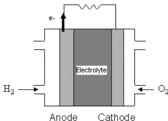
Figure 3 – Schéma général d'une pile à combustible.
