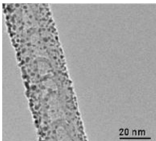
Figure 25 - Nanoparticules de platine déposées par pulvérisation cathodique sur nanotubes de carbone dopés à l'azote<sup>59</sup>.
