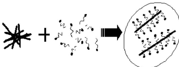
Figure 22 - Effet de l'ajout de surfactants sur un agrégat de nanotubes dans un solvant polaire.
