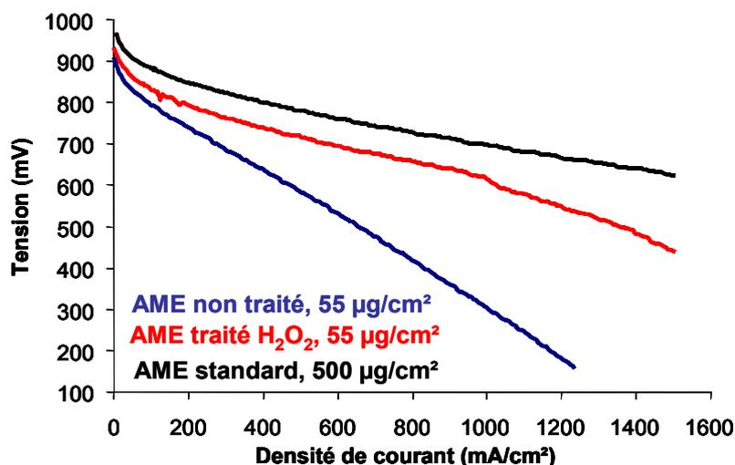
Figure 132 - Courbes de polarisation d'un AME standard, d'un AME comportant deux électrodes NP Pt-1/NT 1/1 / feutre non traitées (60 µg/cm<sup>2</sup>), et d'un AME comportant deux électrodes NP Pt-1/NT 1/1 / feutre (55 µg/cm<sup>2</sup>) traitées à l'eau oxygénée commerciale pendant 20 minutes.
