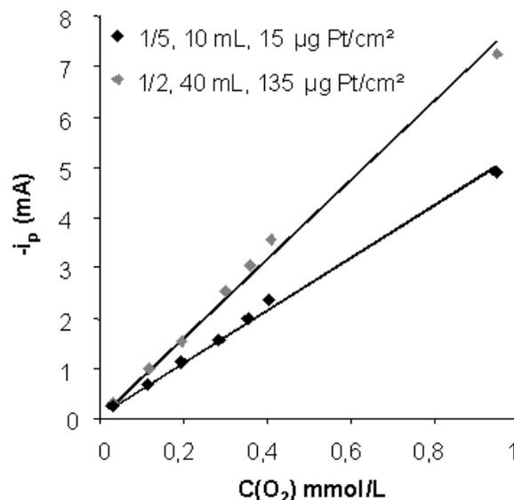
Figure 101 - Graphe de variations du courant de pic en fonction de la concentration d'oxygène pour les deux échantillons de la Figure 100.
