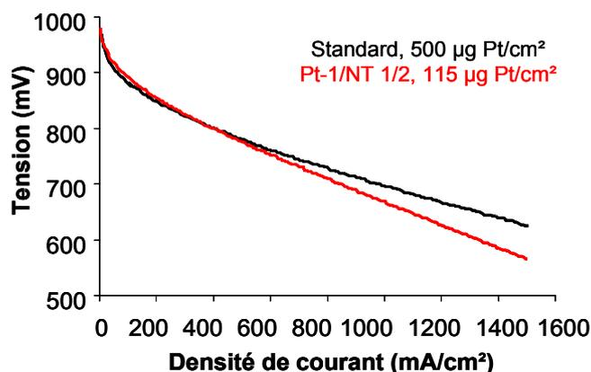
Figure 129 - Courbes de polarisation d'un AME standard et de l'AME comportant une électrode NP Pt-1/NT 1/2 / feutre à  $115\mu\text{g}/\text{cm}^2$  et une électrode standard. Test avec l'électrode NP Pt-1/NT 1/2 / feutre en anode.
