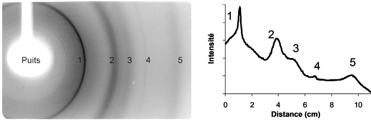
Figure 152 – Cliché et profil de diffraction des rayons X pour un échantillon NP Pt-1/NT 1/2 non traité sur feutre, gratté- 1) Pic de diffraction du carbone sur fond dû au capillaire ; 2) pic (111) du platine ; 3) pic (200) du platine ; 4) Pic associé aux nanotubes de carbone ; 5) pic (220) du platine.
