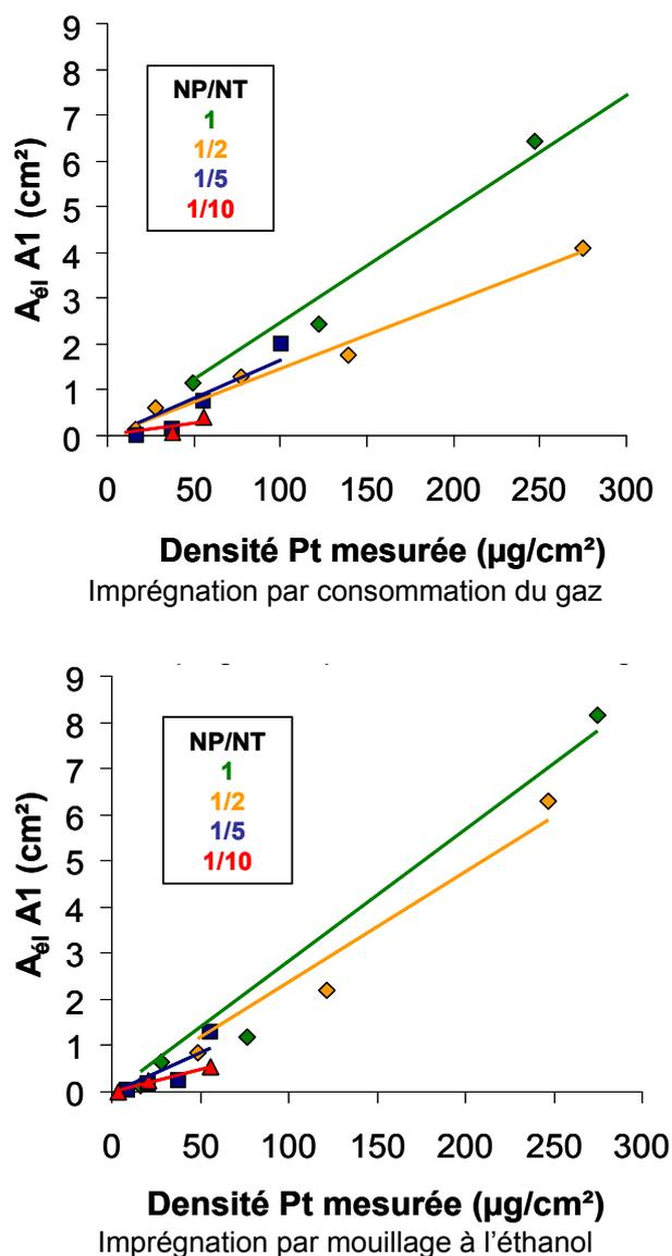
Figure 84 - Aires électroactives déduites des intégrales  $A1$  en fonction de la densité de platine mesurée pour les différents rapports NP Pt-1 / NT, à gauche après imprégnation par consommation du gaz, à droite par mouillage à l'éthanol.
