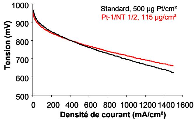
Figure 130 - Courbes de polarisation d'un AME standard et de l'AME comportant une électrode NP Pt-1/NT 1/2 / feutre à 115  $\mu\text{g}/\text{cm}^2$  et une électrode standard. Test avec l'électrode NP Pt-1/NT 1/2 / feutre en cathode.
