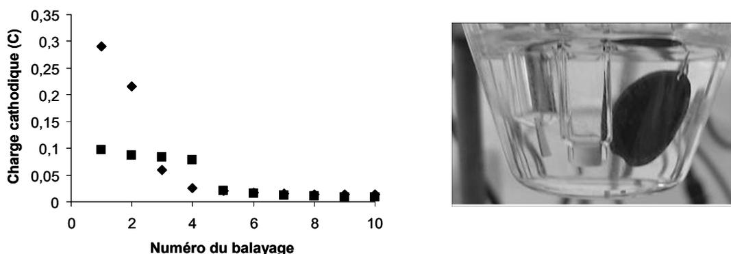
Figure 77 - Charge cathodique consommée par balayage après immersion et bullage d'oxygène pour deux électrodes : 1/1, 10 mL (50  $\mu\text{g Pt/cm}^2$ , losanges) et 1/5, 10 mL (15  $\mu\text{g Pt/cm}^2$ , carrés). A droite, photographie d'une électrode après la première phase : couche active et feutre apparaissent sombres.
