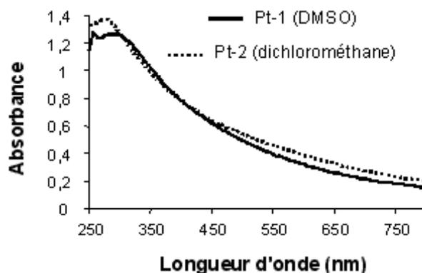
Figure 37 - Spectres UV-visible de nanoparticules Pt-1 et Pt-2 à concentrations égales (50 µg/mL).
