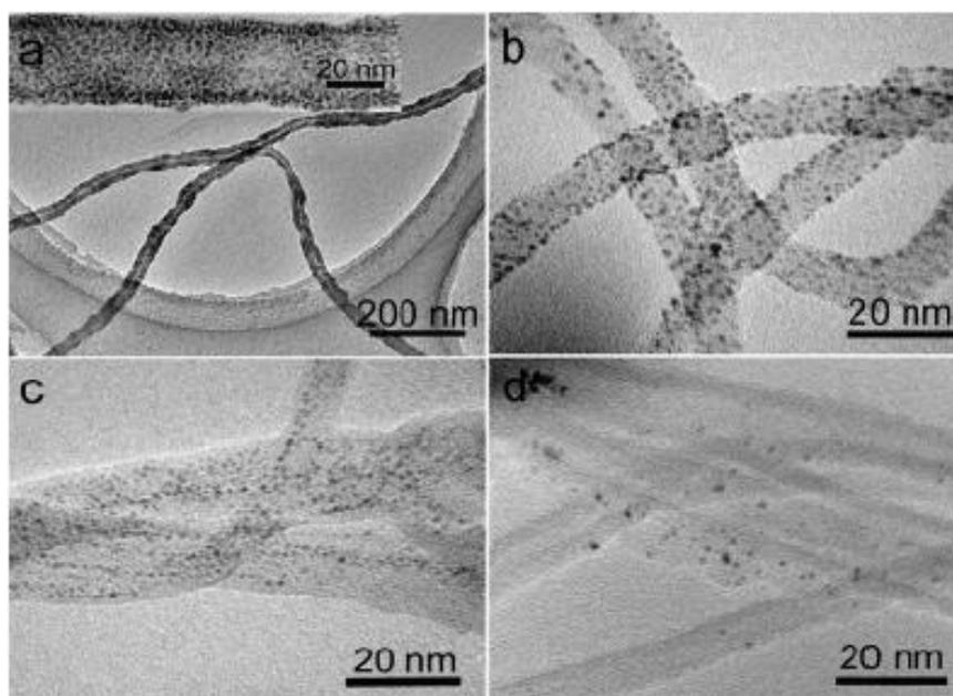
Figure 29 – Images MET de nanoparticules de platine enrobées par la triphénylphosphine sur nanotubes avec différents rapports massiques Pt/C<sup>77</sup> : a) 40,6 %, b) 24 %, c) 19,1 %, d) 3,1 %.
