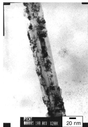
Figure 27 – Image MET de nanoparticules de platine sur nanotube, obtenues par réduction par  $HCHO$ <sup>47</sup>.
