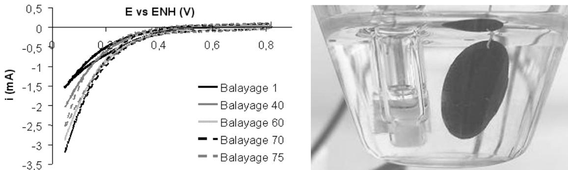
Figure 105 - Voltampérogrammes de consommation du gaz typique d'un échantillon NP Pt-2 / NT 1/1, 10 mL filtrés et photographie de l'électrode après cette étape : feutre et couche active apparaissent sombres.
