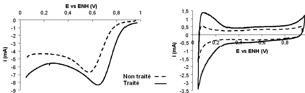
Figure 122 - Voltampérogrammes de réduction de l'oxygène (à gauche) et d'adsorption-désorption des protons en solution désoxygénée (à droite) pour des échantillons non traité et traité 4h à 100°C sous air.
