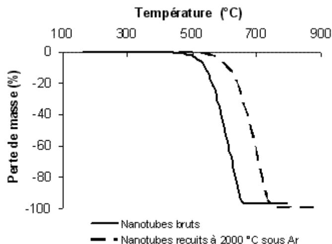
Figure 21 - ATG comparées de nanotubes bruts et recuits<sup>111</sup>.
