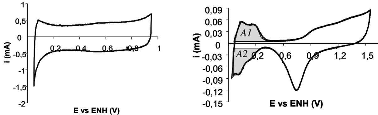
Figure 82 - Voltampérogramme typique d'un échantillon NP Pt-1 / NT 1/1, 10 mL (50  $\mu\text{g Pt}/\text{cm}^2$ ) après imprégnation par consommation du gaz (à gauche) et de platine polycristallin (à droite) dans une solution désoxygénée à l'argon, 100 mV/s.
