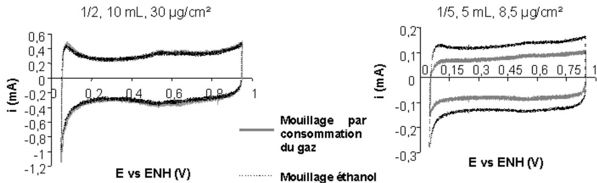
Figure 83 – Voltampérogrammes typiques en solution désoxygénée pour les rapports NP/NT élevés (à gauche) et les rapports NP/NT faibles (à droite) et comparaison des deux méthodes d'imprégnation.
