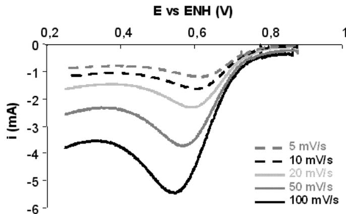
Figure 93 - Famille de voltampérogrammes de réduction de l'oxygène après consommation du gaz en fonction de la vitesse de balayage pour une électrode Pt-1 / NT 1/1, 10 mL filtrés (50 µg Pt/cm<sup>2</sup>).
