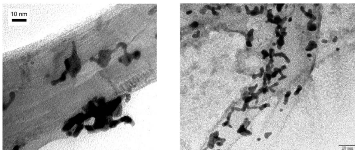
Figure 126 – Clichés MET de composite Pt-1/NT 1/1 (à gauche) et SWNT/Pt (à droite – nanoparticules non enrobées initialement<sup>99</sup>) après traitement électrochimique jusqu'à 1,45 V vs ENH.
