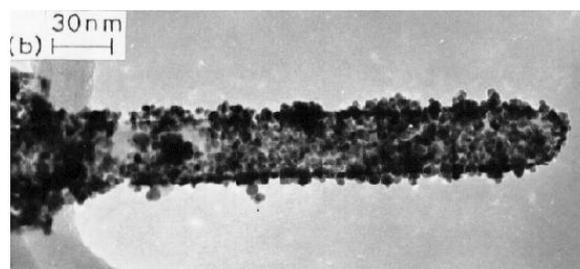
Figure 24 - Nanoparticules de platine sur nanotubes<sup>57</sup>.
