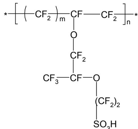
Figure 4 - Formule semi-développée du Nafion®.
