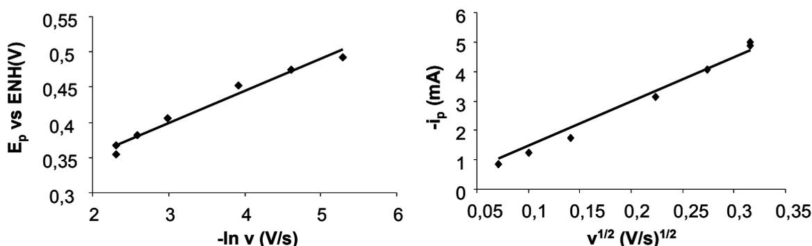
Figure 96 - Potentiel et courant de pic ( $E_p$ ,  $i_p$ ) en fonction de la vitesse de balayage ( $5 < v < 100$  mV/s) pour l'électrode de la Figure 95 (Pt-1 / NT 1/5, 10 mL filtrés,  $15 \mu\text{g Pt/cm}^2$ ).
