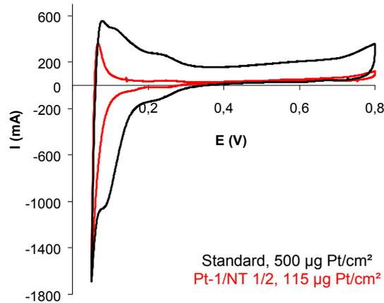
Figure 131 - Voltampérométrie cyclique *in situ* à 50 mV/s (potentiel variant de 50 à 800 mV) de l'AME ne comportant que des électrodes standard et de l'AME comportant une électrode NP Pt-1/NT 1/2 / feutre à 115  $\mu\text{g}/\text{cm}^2$  et une électrode standard. L'électrode NP/NT est positionnée en cathode et est alors soumise à un flux d'azote.
