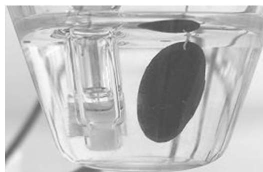
Figure 105 - Voltampérogrammes de consommation du gaz typique d'un échantillon NP Pt-2 / NT 1/1, 10 mL filtrés et photographie de l'électrode après cette étape : feutre et couche active apparaissent sombres.
