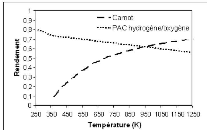
Figure 2 – Comparaison des rendements des moteurs thermique (cycle de Carnot) et électrochimique<sup>6</sup>.
