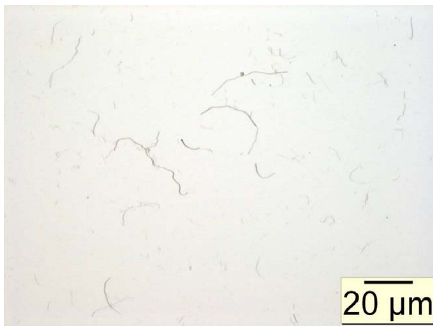
Figure 31 – Vue au microscope optique d'une goutte de dispersion de nanotubes avec Nafion® déposée sur du verre pour comptage et répartition en taille des nanotubes.
