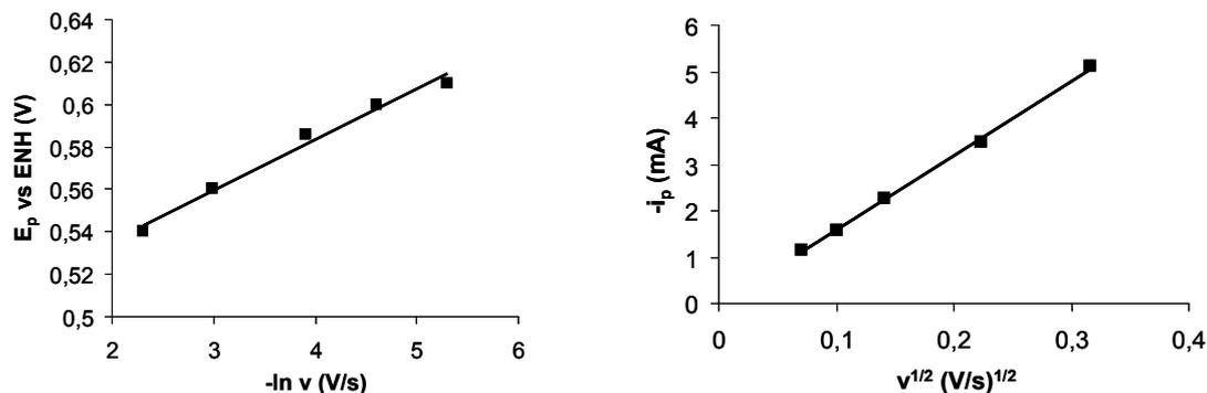
Figure 94 - Potentiel et courant de pic ( $E_p$ ,  $i_p$ ) en fonction de la vitesse de balayage ( $5 < v < 100$  mV/s) pour l'électrode de la Figure 93 (Pt-1 / NT 1/1, 10 mL filtrés,  $50 \mu\text{g Pt/cm}^2$ ).
