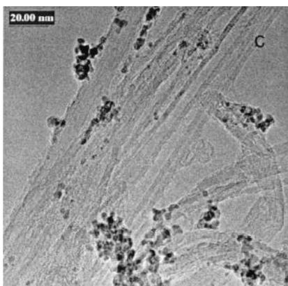
Figure 26 – Image MET de nanoparticules de platine sur nanotubes, obtenues par réduction par  $N_2H_4$ <sup>52</sup>.
