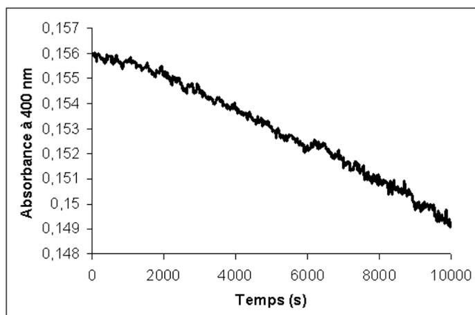
Figure 39 - Absorbance en fonction du temps d'un mélange de nanoparticules Pt-1 dans un mélange DMSO-isopropanol ; 1 volume de nanoparticules à 250  $\mu\text{g/mL}$  mélangé à 25 volumes d'isopropanol.
