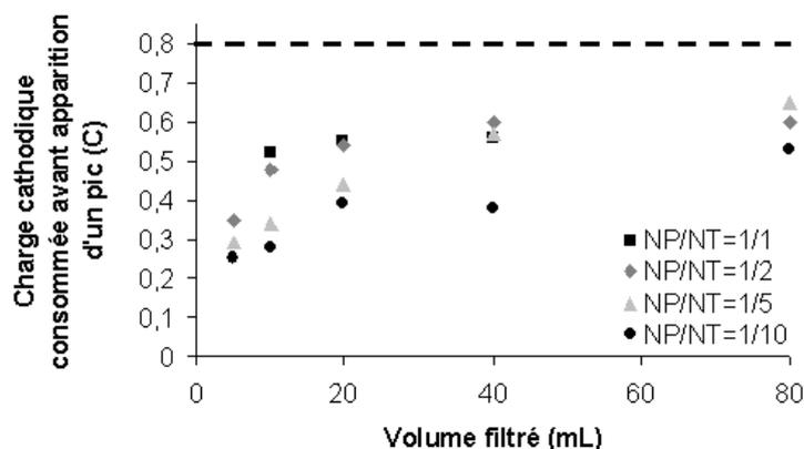
Figure 78 - Charge consommée en fonction du volume filtré et du rapport NP/NT dans la première étape de caractérisation par voltampérométrie cyclique des électrodes. En tirets, charge calculée correspondant à la réduction de la totalité de l'oxygène contenu dans le feutre.
