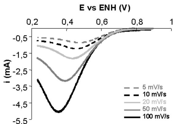
Figure 95 - Famille de voltampérogrammes de réduction de l'oxygène après consommation du gaz en fonction de la vitesse de balayage pour une électrode Pt-1 / NT 1/5, 10 mL filtrés ( $15 \mu\text{g Pt/cm}^2$ ).
