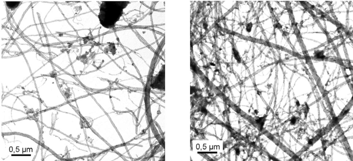
Figure 51 – Clichés MET d'associations Pt-1 / NT 1/1 thermostatées à  $15 \text{ °C}$  (à gauche) et à  $30 \text{ °C}$  (à droite) comparées à faible grossissement (8000x). De gros agrégats (en noir) sont visibles.
