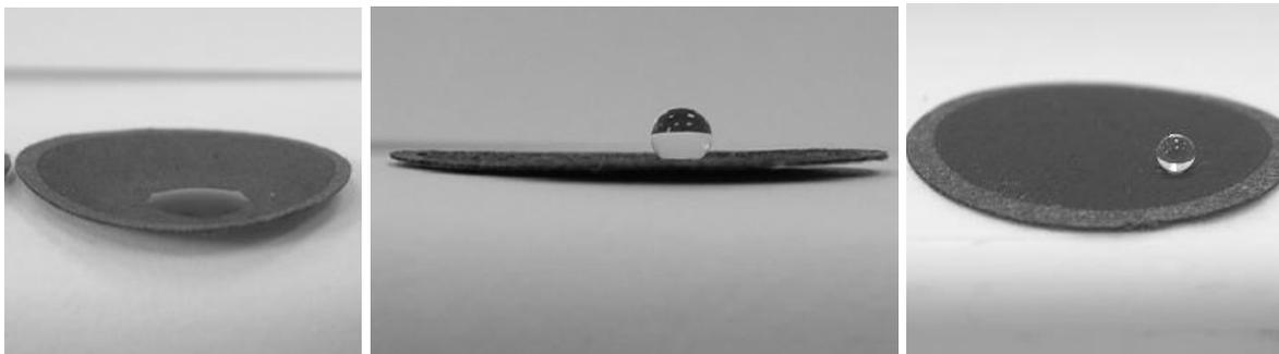
Figure 70 - Photographies d'électrodes de 10 mL filtrés sur lesquelles a été déposée une goutte d'eau de taille millimétrique - de gauche à droite, rapports NP/NT 1/1 (imprégnation), 1/2 (Wenzel, la goutte accroche au dépôt), 1/10 (superhydrophobie, goutte parfaitement sphérique).
