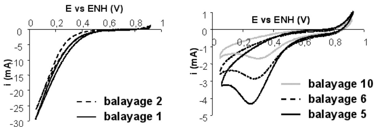
Figure 76 – Voltampérogrammes obtenus après saturation du milieu en oxygène sur une électrode NP Pt-1/NT 1/5, 10 mL (14  $\mu\text{g}$  Pt/cm<sup>2</sup>).
