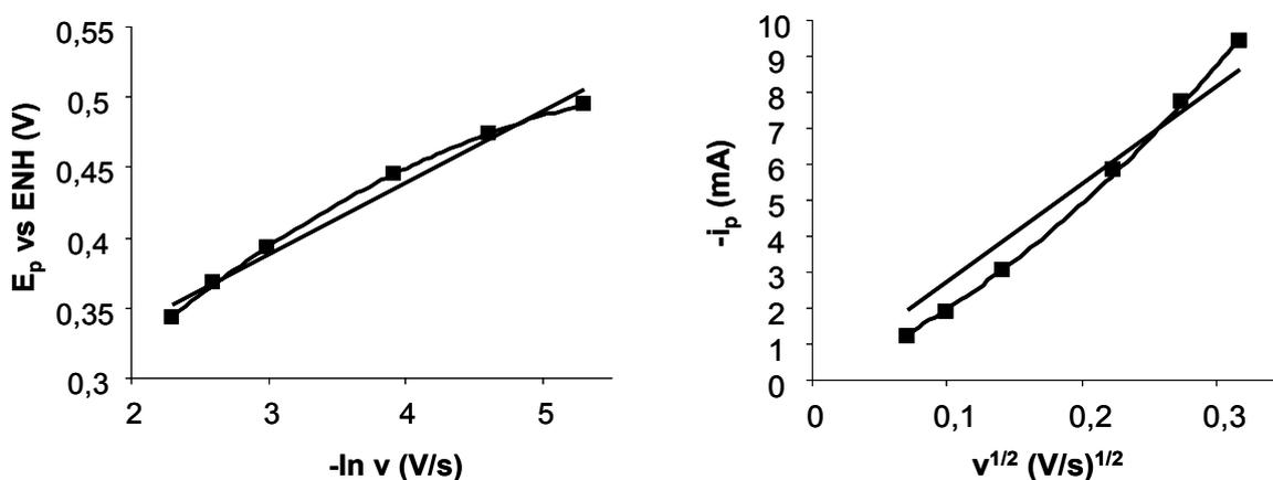
Figure 97 - Potentiel  $E_p$  (vs ENH) et courant de pic  $i_p$  en fonction de la vitesse de balayage pour une électrode Pt-1 / NT 1/10, 40 mL filtrés ( $28 \mu\text{g Pt/cm}^2$ ) après imprégnation par consommation du gaz : déviation par rapport à la linéarité.
