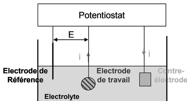
Figure 140 - Montage à trois électrodes et potentiostat.
