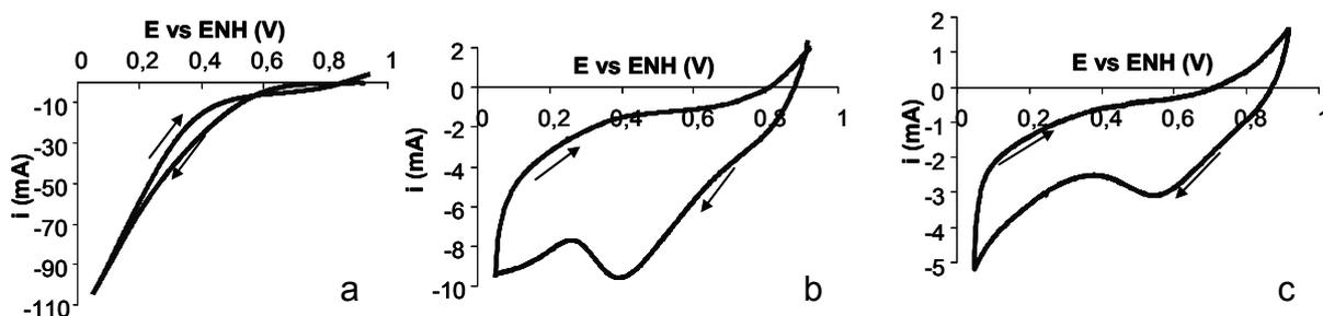
Figure 75 - Voltampérogrammes obtenus (a : premier, b : 2è, c : 3è balayage) après saturation du milieu en oxygène sur une électrode NP Pt-1 / NT 1/1,  $V_f=10$  mL (50  $\mu\text{g Pt}/\text{cm}^2$ ) – Sens de balayage indiqué par les flèches.
