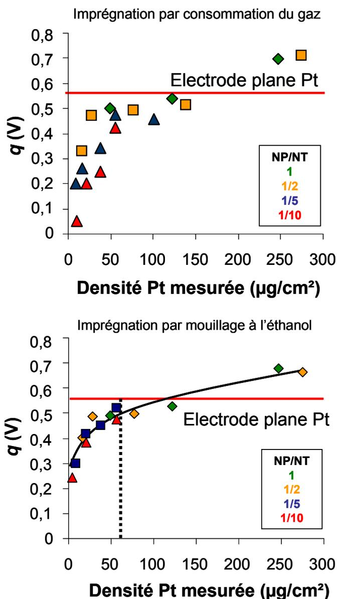
Figure 102 - Paramètre cinétique  $q$  en fonction de la densité de platine mesurée pour les différents rapports NP Pt-1/NT après imprégnation par consommation du gaz (à gauche) et par mouillage à l'éthanol (à droite). Nous constatons peu de variations au-dessus de  $60 \mu\text{g}/\text{cm}^2$  (ligne pointillée).
