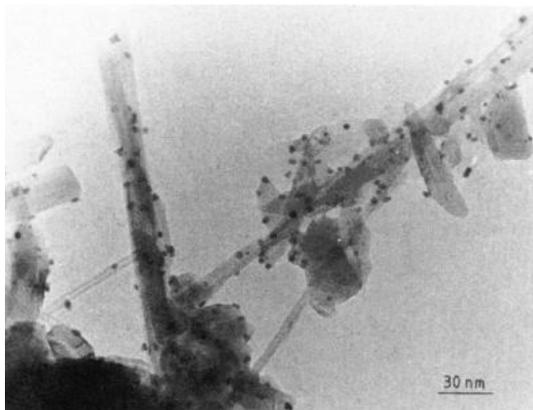
Figure 23 - Nanoparticules de ruthénium sur nanotubes<sup>56</sup>.
