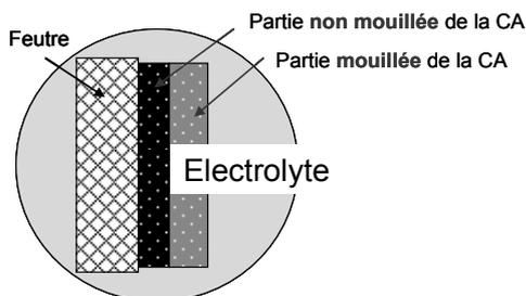
Figure 74 - Schéma représentant une électrode plongée dans l'électrolyte.
