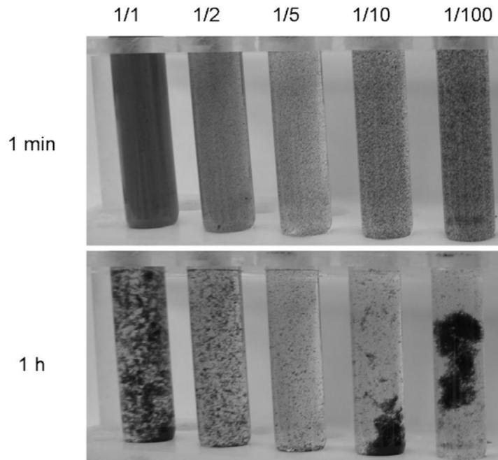
Figure 60 - Aspect des associations NP Pt-1 / NT de gauche à droite : 1/1, 1/2, 1/5, 1/10, 1/100, 1 minute (en haut) et une heure (en bas) après agitation manuelle des tubes ensemble.
