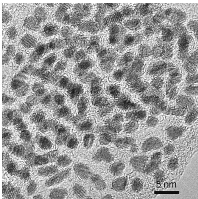
Figure 10 - Cliché MET HR de nanoparticules Pt-0.
