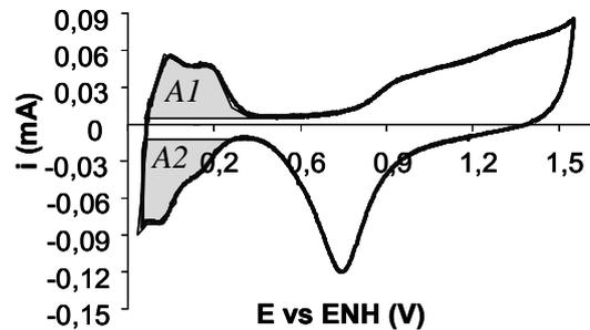
Figure 142 - Voltampéromètre expérimental sur électrode de platine polycristallin dans  $HClO_4$  1M - vitesse de balayage 100 mV/s.
