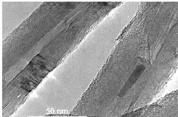
Figure 137 - Nanotubes multi-parois synthétisés au laboratoire observés au MET : vue d'une particule de fer encapsulée dans le canal central d'un nanotube (à droite)<sup>111</sup>.
