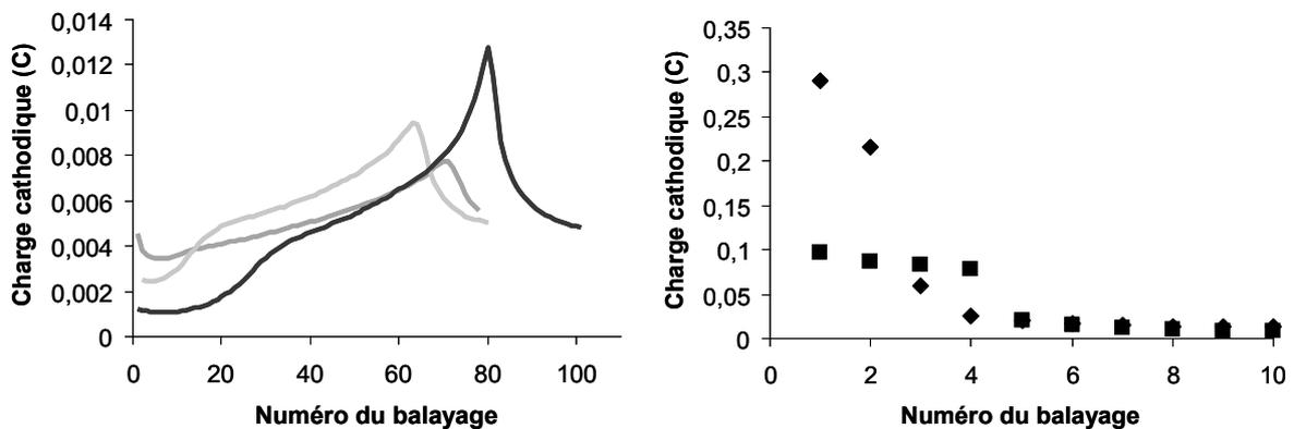
Figure 106 - Graphes de charge cathodique consommée par balayage pour trois échantillons identiques de NP Pt-2 / NT 1/1, 10 mL ( $60 \mu\text{g Pt}/\text{cm}^2$ ). Les charges totales consommées sont proches : 0,34, 0,30 et 0,40 C (à gauche). A droite, rappel des graphes obtenus pour deux électrodes Pt-1 / NT 1/1 et 1/5, 10 mL filtrés.
