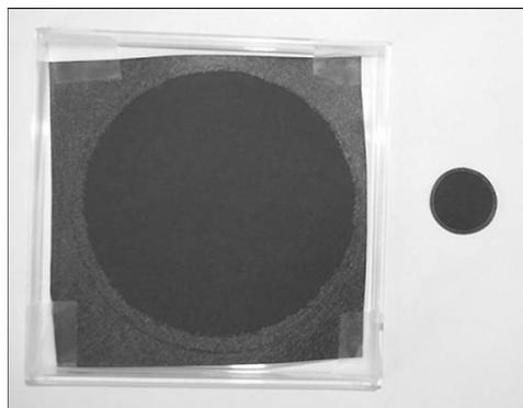
Figure 128 - Electrode obtenue par filtration pour les tests en pile, de surface  $\sim 40 \text{ cm}^2$  (à gauche). A droite, électrode utilisée pour les caractérisations *ex situ* ( $2,5 \text{ cm}^2$ ).
