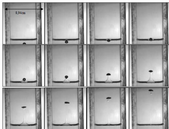
Figure A4.1. Franchissement de l'interface Emkarox 50% massique / huile de silicone par une bulle de 6 mm de diamètre équivalent en ascension. Images obtenues par caméra rapide numérique
