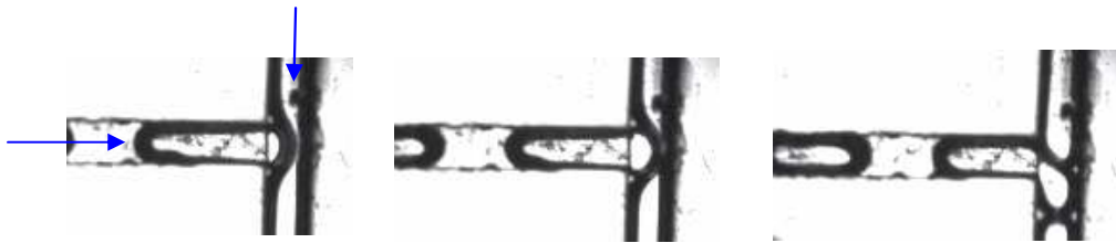
Figure V.03. Etude de la coalescence de bulles dans de l'eau + 3% SDS dans un micro-mélangeur en T de 500\ \mu\text{m} . Les courants d'entrées sont perpendiculaires.
