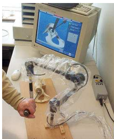
Fig. 3.2: Le système de planification NCCR utilise des images TDM pour les transformer en modèles graphiques 3D du pelvis et du fémur. Pendant la chirurgie il est possible d'utiliser un appareil de navigation pour guider le médecin dans le positionnement des prothèses.
