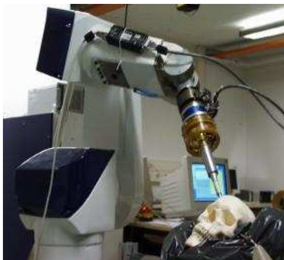
Fig. 3.4: Le bras de robot du système Caspar effectue l'implantation de la prothèse fémorale selon la position et l'orientation choisie dans l'analyse préopératoire.
