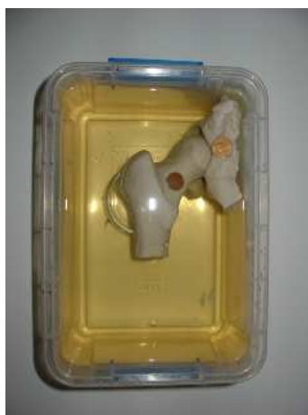
Fig. 8.8: Dispositif pour les essais de prises d'images échographiques. Le cotyle et le fémur en plâtre sont placés dans une bassine remplie de gélatine.
