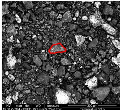
FIGURE 3.14. Image MEB du composite “Sn-0,4 CaSiO<sub>3</sub>” en mode rétrodiffusion.
