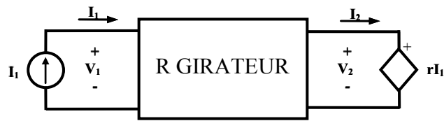
Figure 4.26 : Girateur de type R avec tension de sortie contrôlée assurant la conversion Courant - Tension.
