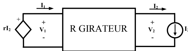
Figure 4.28 : Girateur de type R avec tension d'entrée contrôlée assurant la conversion Tension - Courant.
