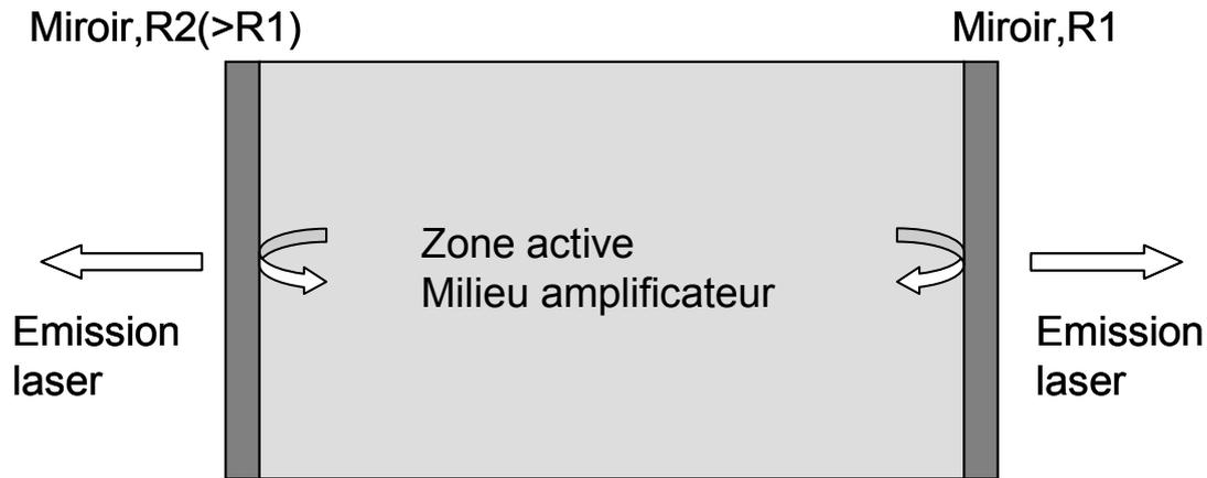
**Fig.1-1** : Schéma du principe de fonctionnement d'un laser
