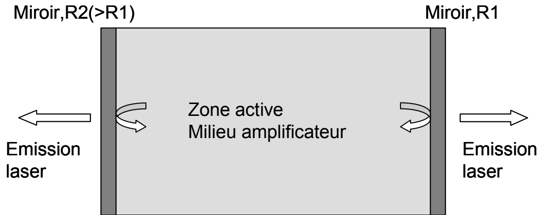
Fig.1-1 : Schéma du principe de fonctionnement d'un laser
