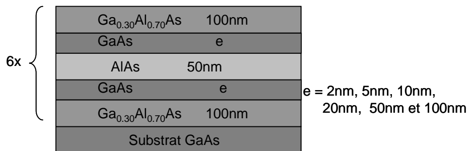
Fig. 4-8 : Structure réalisée pour l'étude de l'influence sur l'oxydation de l'AlAs de ses couches de GaAs voisines.
