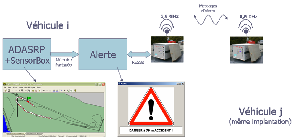
Figure 5.18. Architecture logicielle et matérielle de la fonction Alerte.
