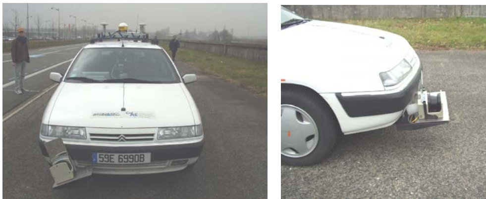
Figure 3.5. Montage d'un télémètre SICK à balayage à l'avant de STRADA.
