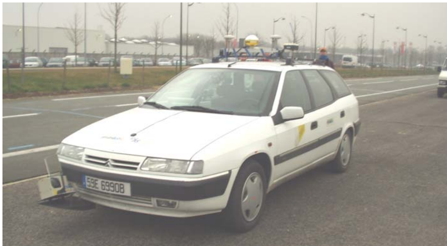
Figure 4.22. Le véhicule expérimental STRADA avec 5 récepteurs GPS (3 Trimble et 2 Thales) sur le circuit de Satory en mars 2004.
