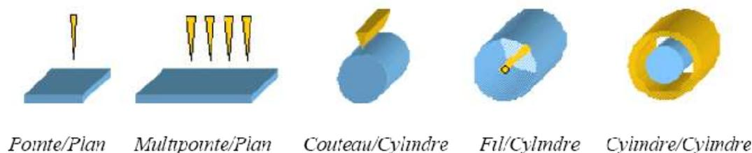
**Figure 1-11 Principe de la décharge couronne**
