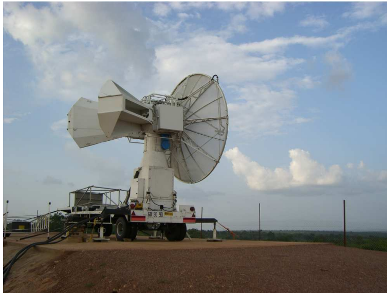
FIG. 2.1 – Le Radar Doppler polarimétrique en bande C RONSARD sur sa remorque, déployé sur le site de Kopargo au Bénin lors de la SOP de AMMA durant l'été 2006.
