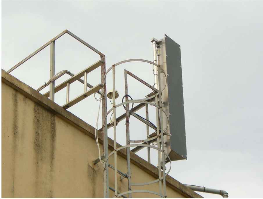
FIG. 2.5 – Le récepteur bistatique du DLR déployé à Kolokonde au Benin durant AMMA
