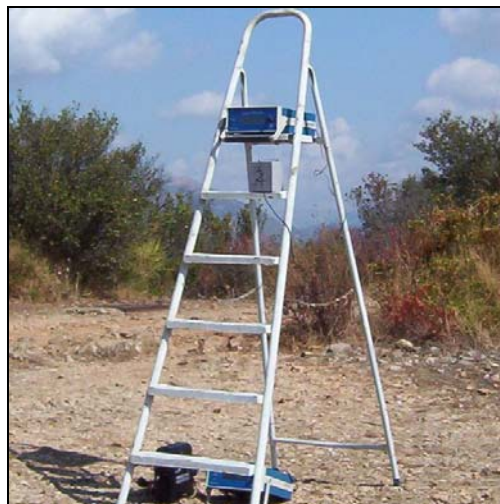
Figure 5.11 Dispositif permettant d’étudier l’influence du sol sur les concentrations d’ozone.
