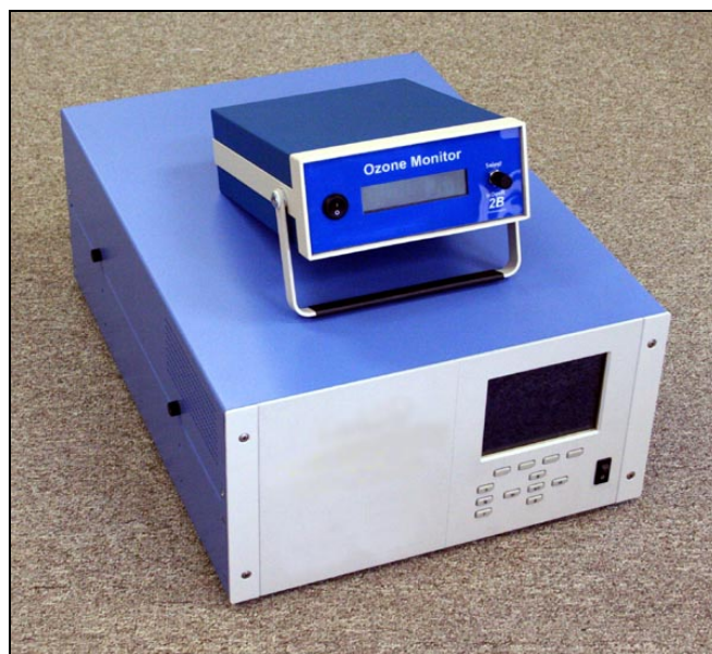
Figure 5.1 Comparaison d’un analyseur d’ozone classique et de celui utilisé pour les mesures itinérantes.
