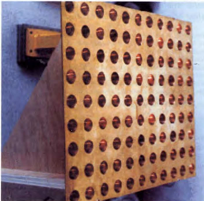
Figure 1. Les biréseaux sont formés de 9 rangées de 11 cavités, soit des panneaux de 396 \times 324 mm 2 .
