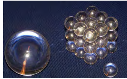
Figure 11 : agrégat 27 sphères comparé à une sphère unitaire et à la sphère diélectrique étudiée précédemment de diamètre 50 mm
