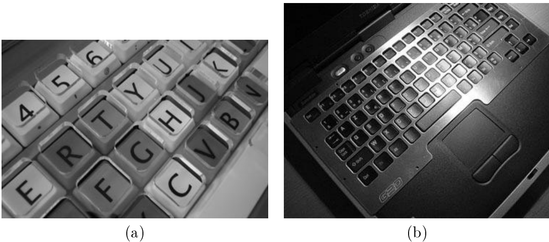
FIG. 2.19 – Guide-doigt : en option sur le clavier BigKey (a), version en aluminium pour ordinateur portable (b).
