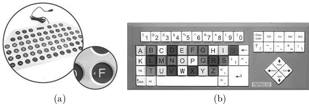
FIG. 2.17 – Claviers grand format : King keyboard de Tash(a) et BigKey (b).
