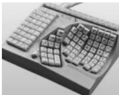
FIG. 2.21 – Clavier ergonomique MALTRON pour main droite.
