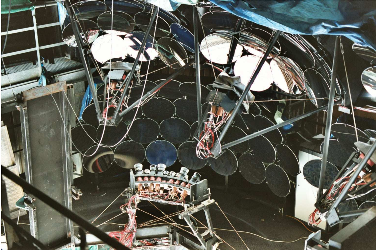
FIG. 4.3 – Miroirs secondaires et photomultiplicateurs installés dans la partie supérieure de la tour (sont visibles ici les deux niveaux les plus hauts parmi les trois de l’optique secondaire).
