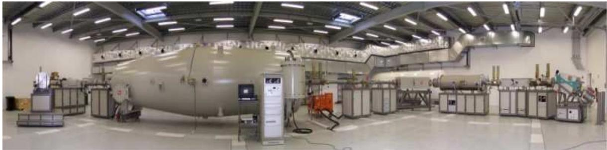
**Fig. 8-6:** Photographie du spectromètre de masse par accélération (AMS) utilisé au CEREGE (<http://www.cerege.fr>).
