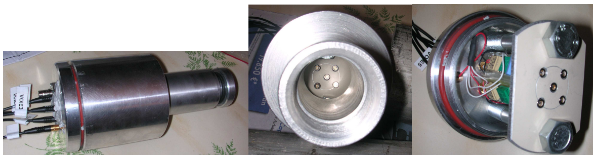
Figure 5.4 : Notre dispositif à 5 photodiodes installé sur le télescope de 60 cm.
