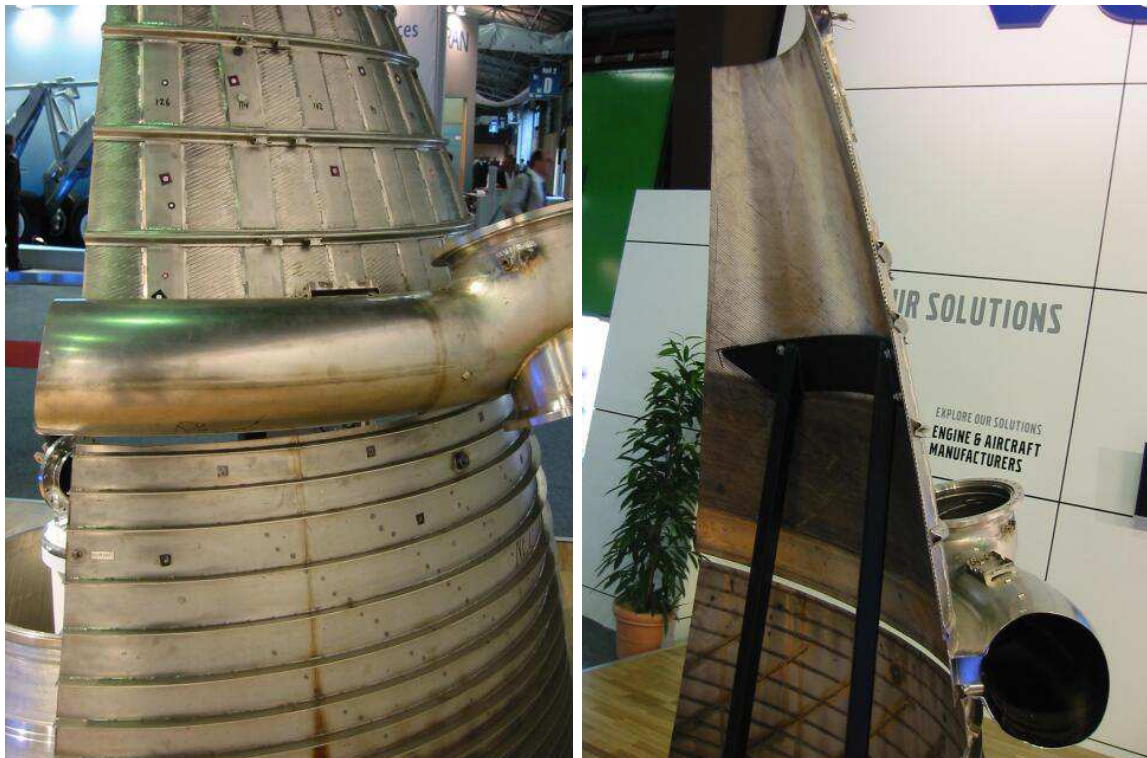
FIG. 6.1 – Divergent du moteur Vulcain 2, dans sa version renforcée (photos prises au salon du Bourget – juin 2005).
